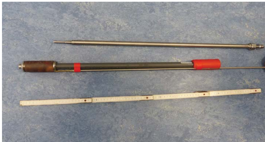
Abbildung 2.3: Hydraulischer Kupferpacker mit Messgestänge für Konvergenz-Messgerät BGKM 30 (Stoß und Firste)
