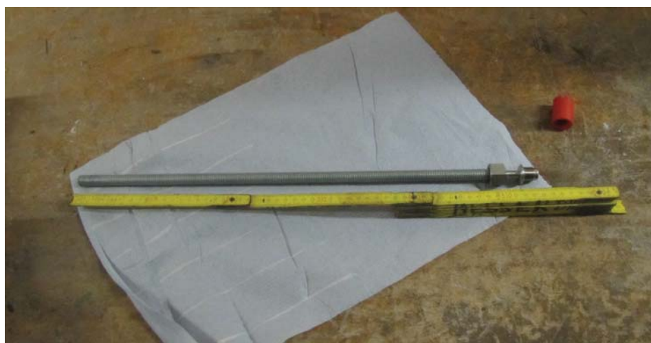
Abbildung 2.4: Konvergenzbolzen für Konvergenz-Messgerät BGKM 30 (Sohle)
