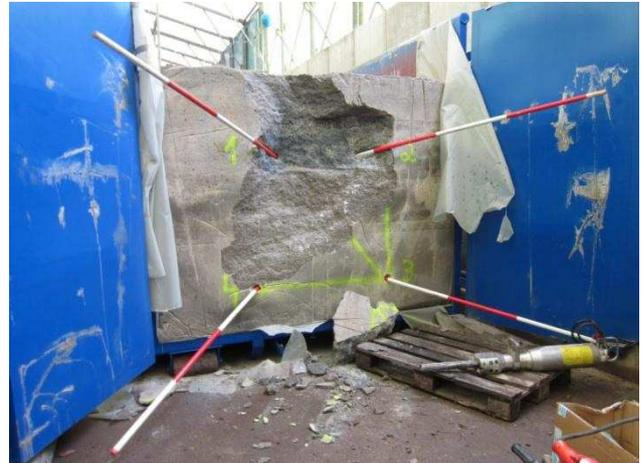
Abbildung 74: Abtragsergebnis des Spaltgeräts nach dem zweiten Spaltvorgang.
