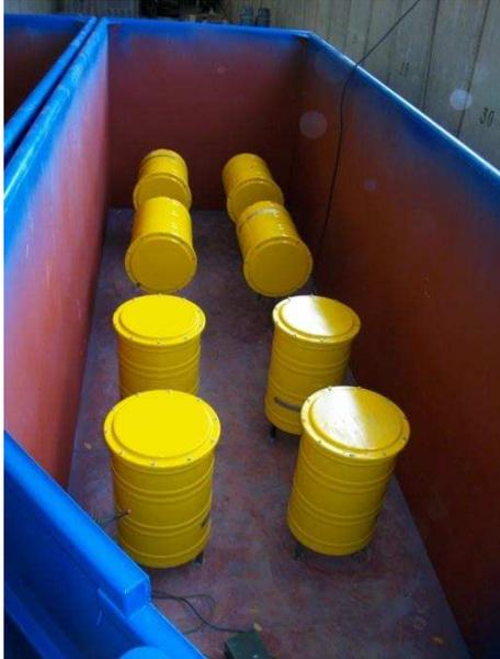
Abbildung 11: Versuchscontainer mit aufgelagerten Gebinden vor der Betonage.
