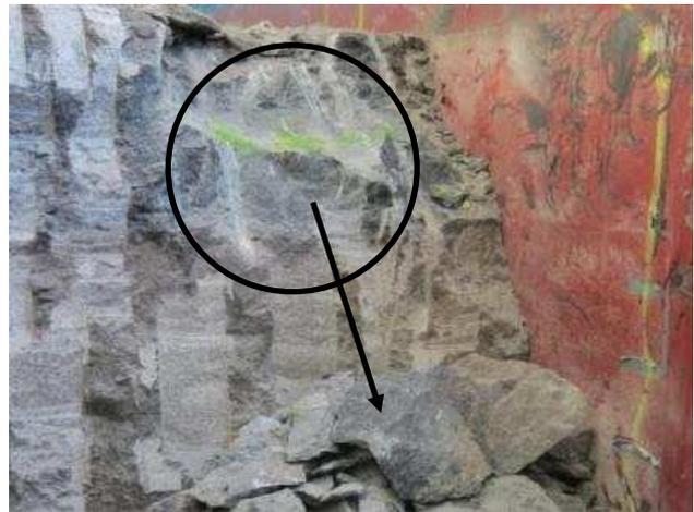
Abbildung 66: Mit Spitzmeißel erzeugter Abtrag aus dem Steinsalzbetonblock.
