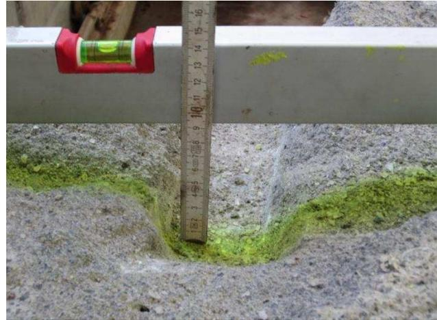
Abbildung 34: Eindringtiefe im Steinsalzbeton bei schlagender Bearbeitung.
