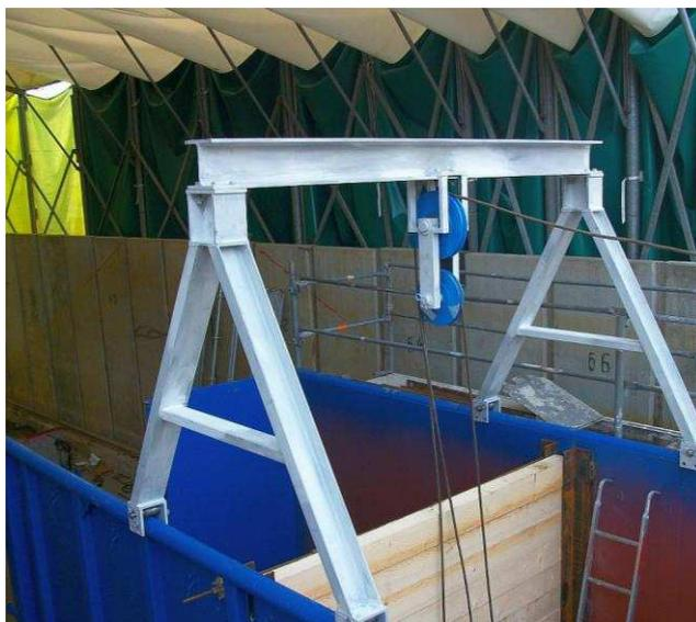
Abbildung 86: A-Bock auf Versuchscontainer für die Löseversuche positioniert.
