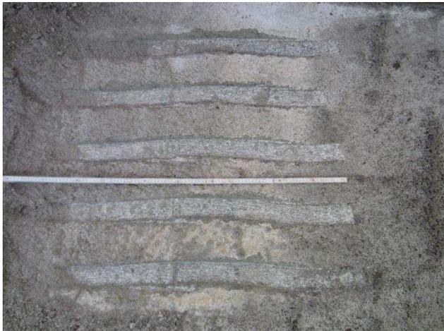
Abbildung 28: Schürfspur des Löffels im Steinsalzbeton.
