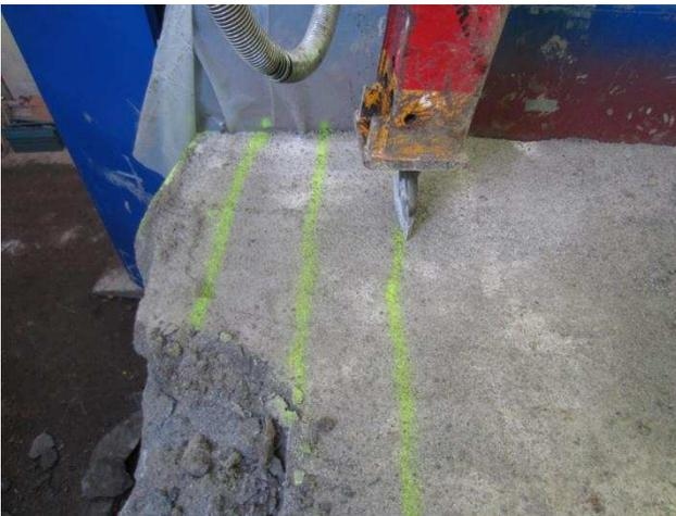
Abbildung 63: Flachmeißel am Steinsalzbetonblock, 90 cm zur Abbruchkante.
