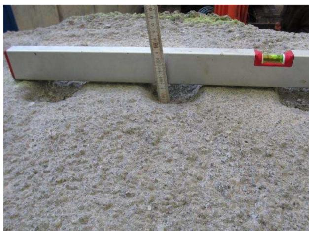
Abbildung 26: Einschlagtiefe der Löffelzähne im Steinsalzbeton beim „Schlagen“.
