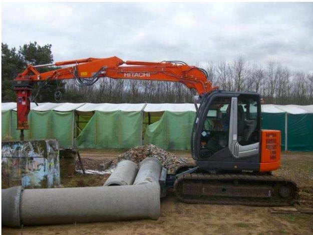
Abbildung 56: Vertikale Meißelposition am Betonblock.
