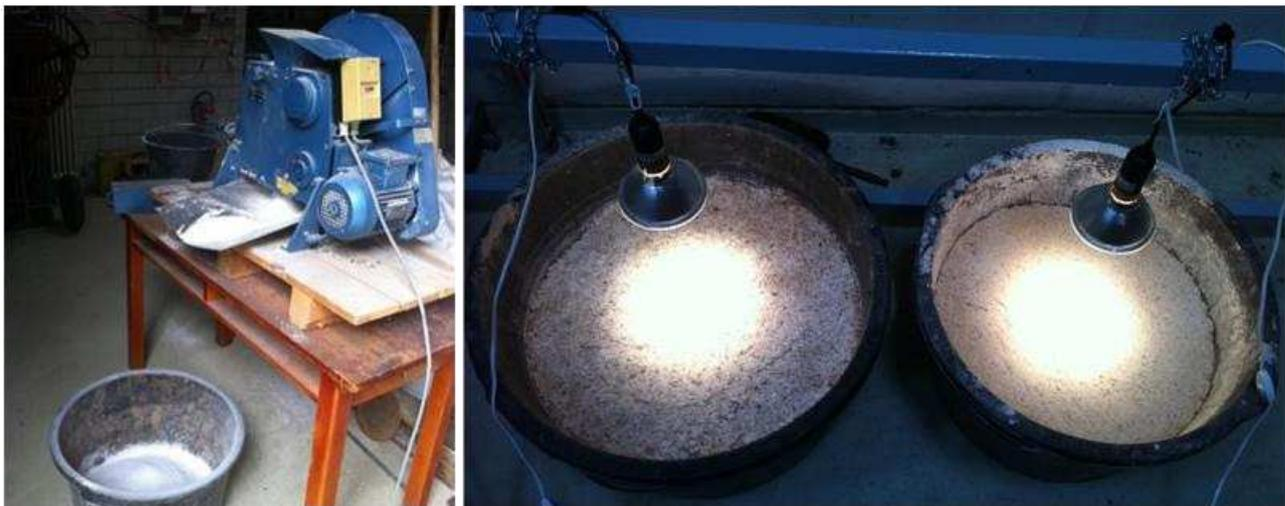
Abbildung 2: Eingesetzter Backenbrecher zum Zermahlen von Salzgrus (links), Wärmelampen zum Beschleunigen des Verfestigungsvorgangs von Salzgrus (rechts).
