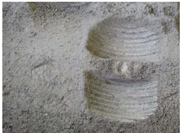
Abbildung 45: Fräsbild in Steinsalzbeton.
