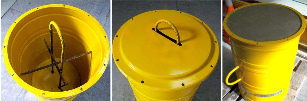
Abbildung 89: Vorbereitung der Gebinde für die Zugversuche.
