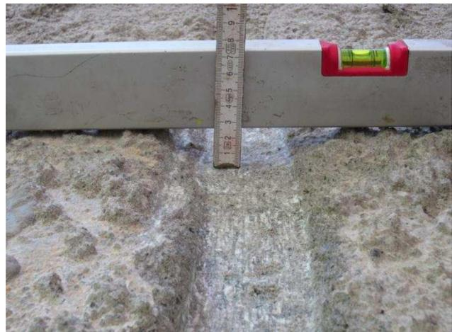
Abbildung 29: Eindringtiefe der Löffelzähne im Steinsalzbeton.
