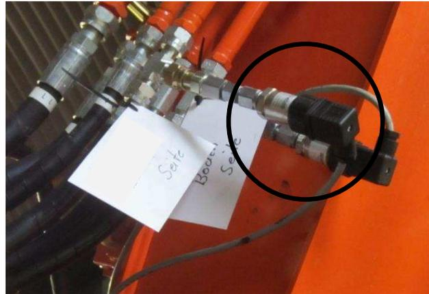
Abbildung 18: Druckmessumformer des Herstellers Hydac International GmbH vom Typ HDA 4745-A-600-000 am Trägergerät.
