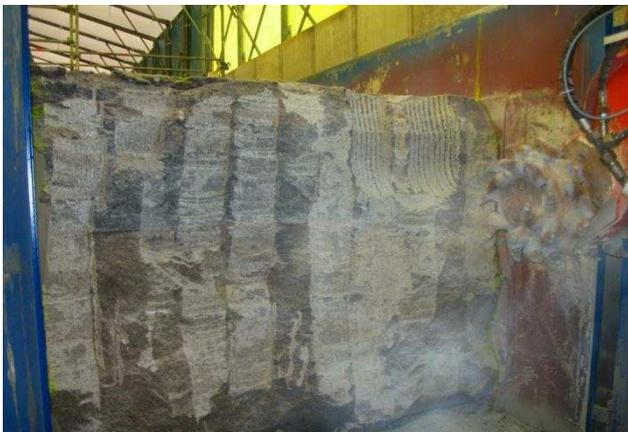
Abbildung 47: Steinsalzbetonblock vor dem Fräsen.
