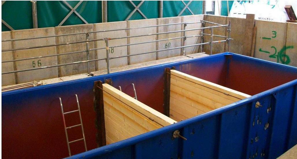
Abbildung 85: Versuchscontainer mit Kammerabtrennung für Löseversuche.
