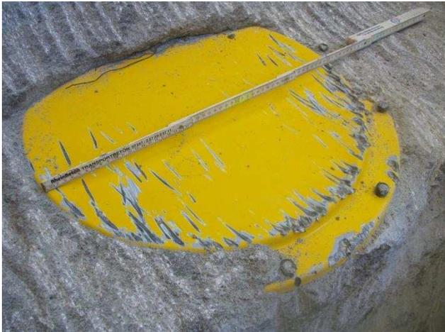
Abbildung 51: Frässpuren auf dem Gebindedeckel.
