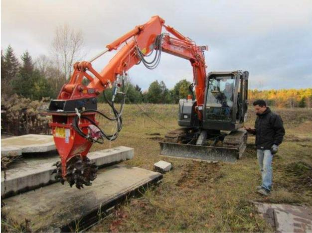
Abbildung 41: Referenzversuche mit der Hydraulikfräse in Beton.
