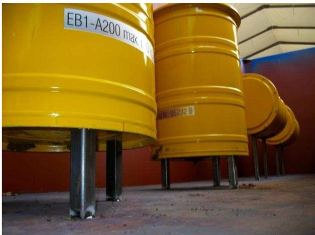
Abbildung 9: Auflagerungssituation der stehenden Gebinde im Versuchscontainer.
