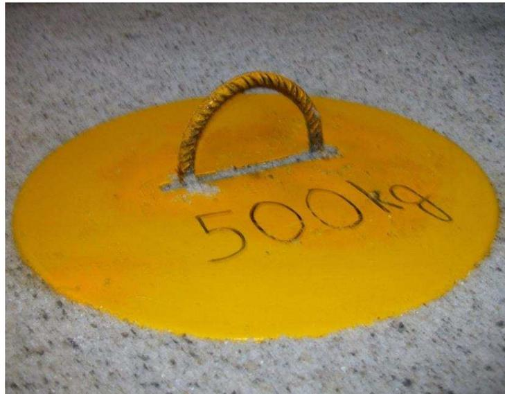
Abbildung 98: Für Zugversuche stehend eingebautes Gebinde.
