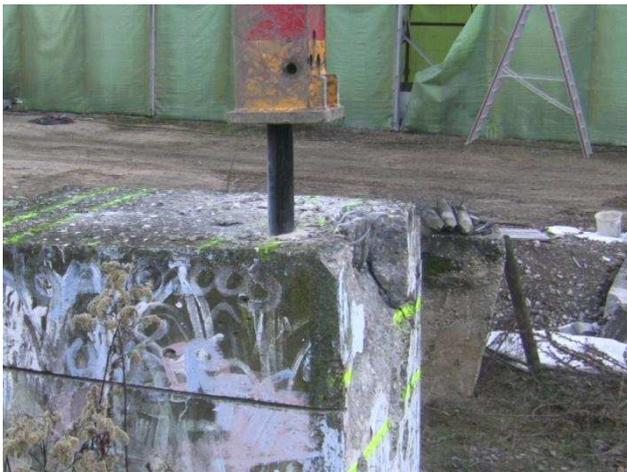
Abbildung 59: Meißelversuch mit dem Spitzmeißel am Beton.
