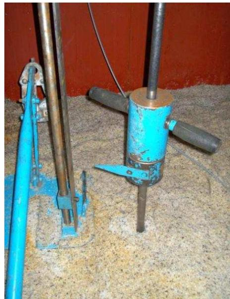
Abbildung 94: Rammsonde beim Einsatz.
