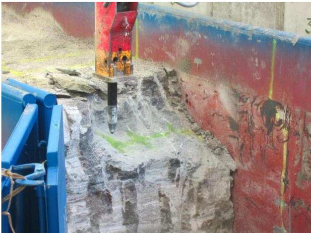
Abbildung 65: Ansatzpunkte im Steinsalzbetonblock für Test mit Spitzmeißel.
