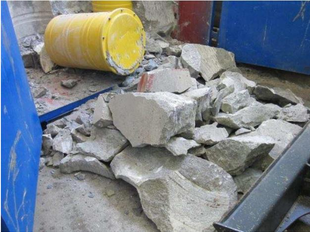
Abbildung 67: Durch Flachmeißelversuch erzeugte Bruchstücke aus Steinsalzbeton.
