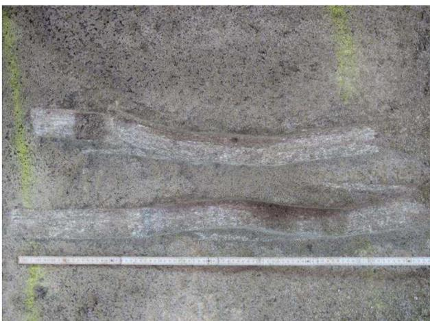
Abbildung 37: Schürfspuren des Reißzahns im Steinsalzbeton.
