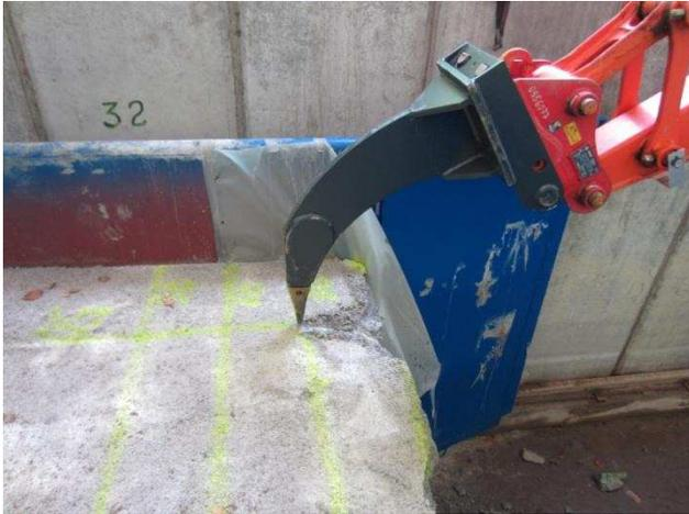
Abbildung 33: Scherversuch am Steinsalzbeton mit dem Reißzahn.
