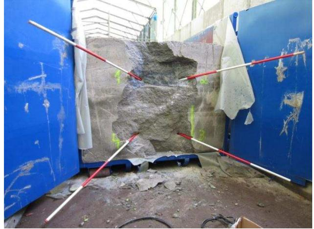
Abbildung 78: Abtragsergebnis des Spaltgeräts nach dem vierten Spaltvorgang.
