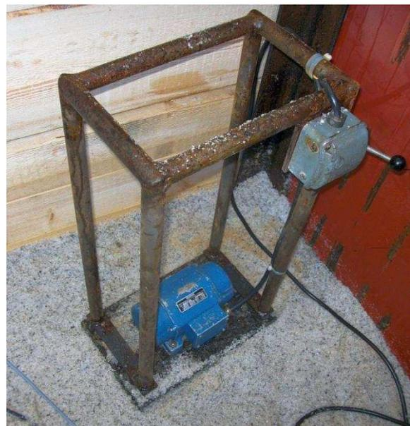
Abbildung 96: Zur Salzverdichtung eingesetzte Rüttelplatte .
