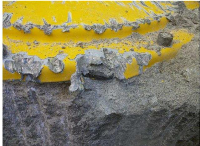
Abbildung 52: Beschädigungen am Gebindedeckel.
