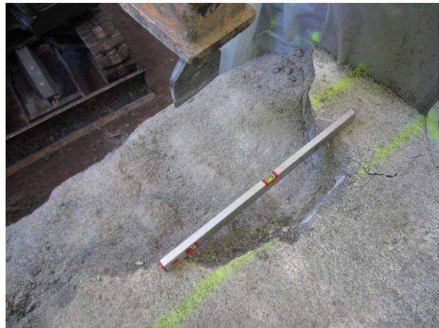
Abbildung 64: Mit Flachmeißel erzeugter Ausbruch aus dem Steinsalzbetonblock.
