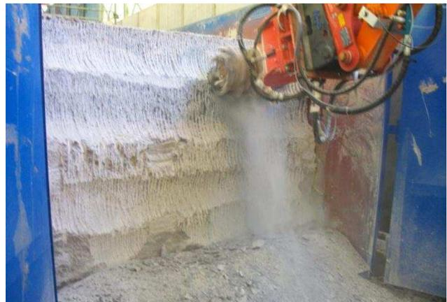
Abbildung 48: Fräsversuch am Steinsalzbeton.
