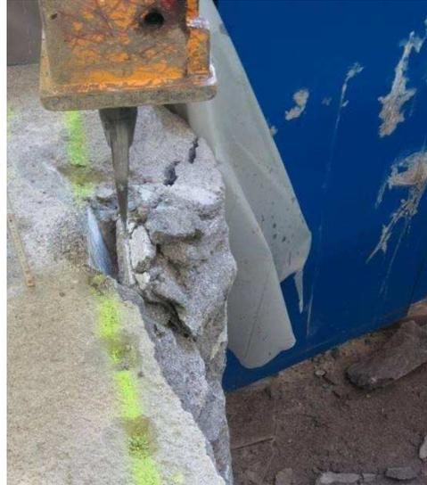
Abbildung 62: Mit Flachmeißel gelöstes Bruchstück aus dem Steinsalzbeton.
