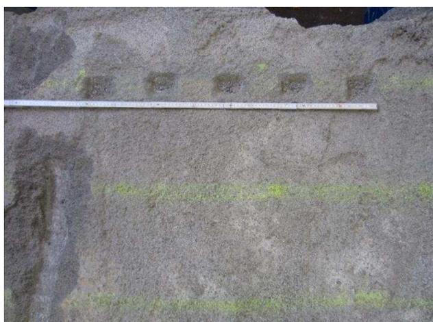
Abbildung 25: Einschlagpunkte der Löffelzähne im Steinsalzbeton beim „Schlagen“.
