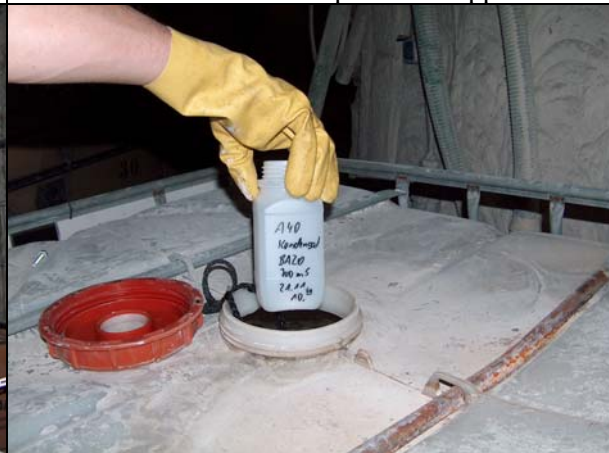
Photo 24: 700-m-Sohle, BA 20, 1-m 3 -TB mit Kondensat, Proben A38 – A40
