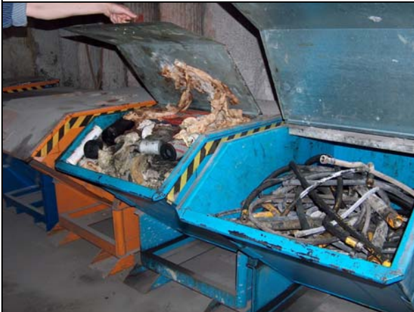
Photo 03: 490-m-Sohle, KfZ-Werkstatt, Behälter für ölhaltige Abfälle (links); Probe A3
