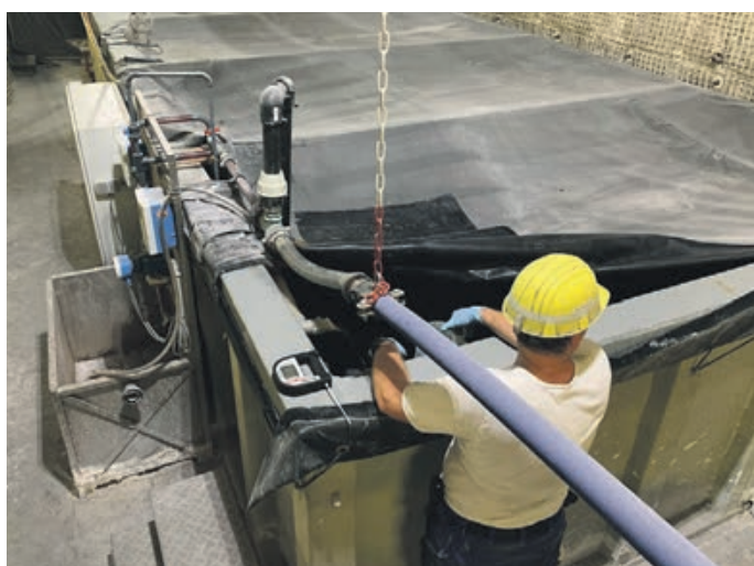
Die gesammelte Lösung an der Hauptauffangstelle auf der 658-Meter-Ebene hatte bereits mit der Grubenluft Kontakt. Dabei verändert sich die chemische Zusammensetzung, so dass eine belastbare Auswertung nicht mehr möglich ist.
