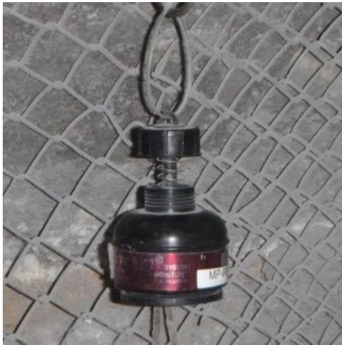
Elektret zur Rn-222 Messung
