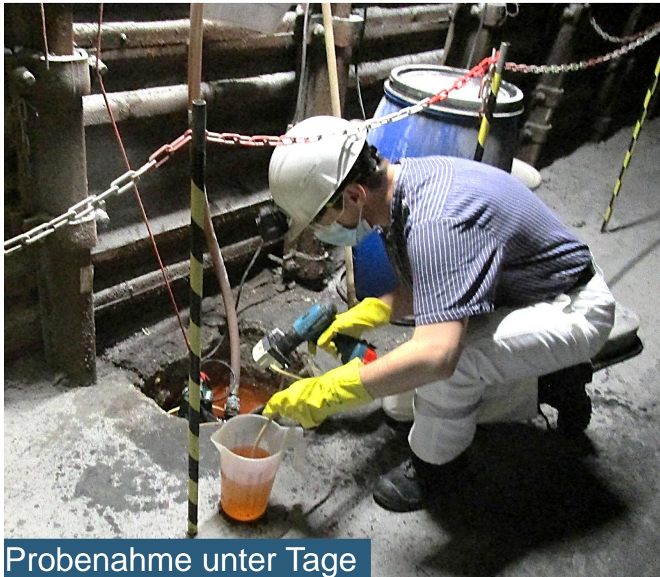
Vorbereitung der Probe für radiologische Messung
