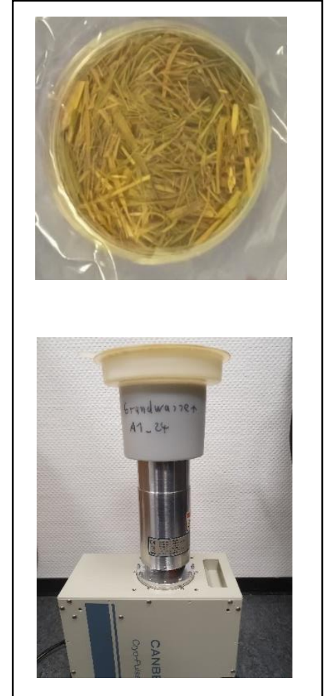
Oben: Bewuchsprobe in Petrischale Unten: Wasserprobe in 0,85 l Marinellibecher auf dem Gamma-Detektor.
