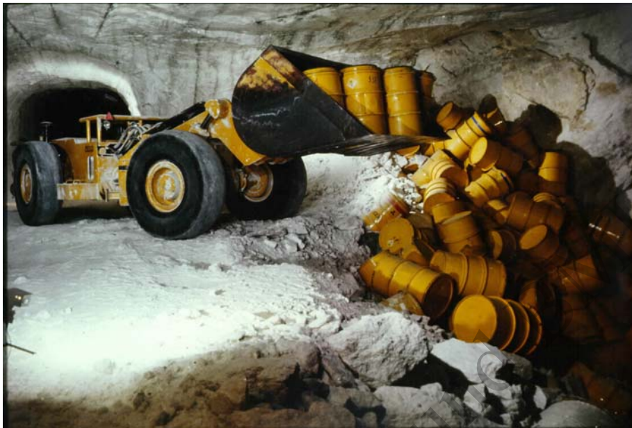
Abbildung 2: Schopflader beim Abkippen radioaktiver Abfallgebinde in Kammer 8/750 (Foto GSF FB Asse).
