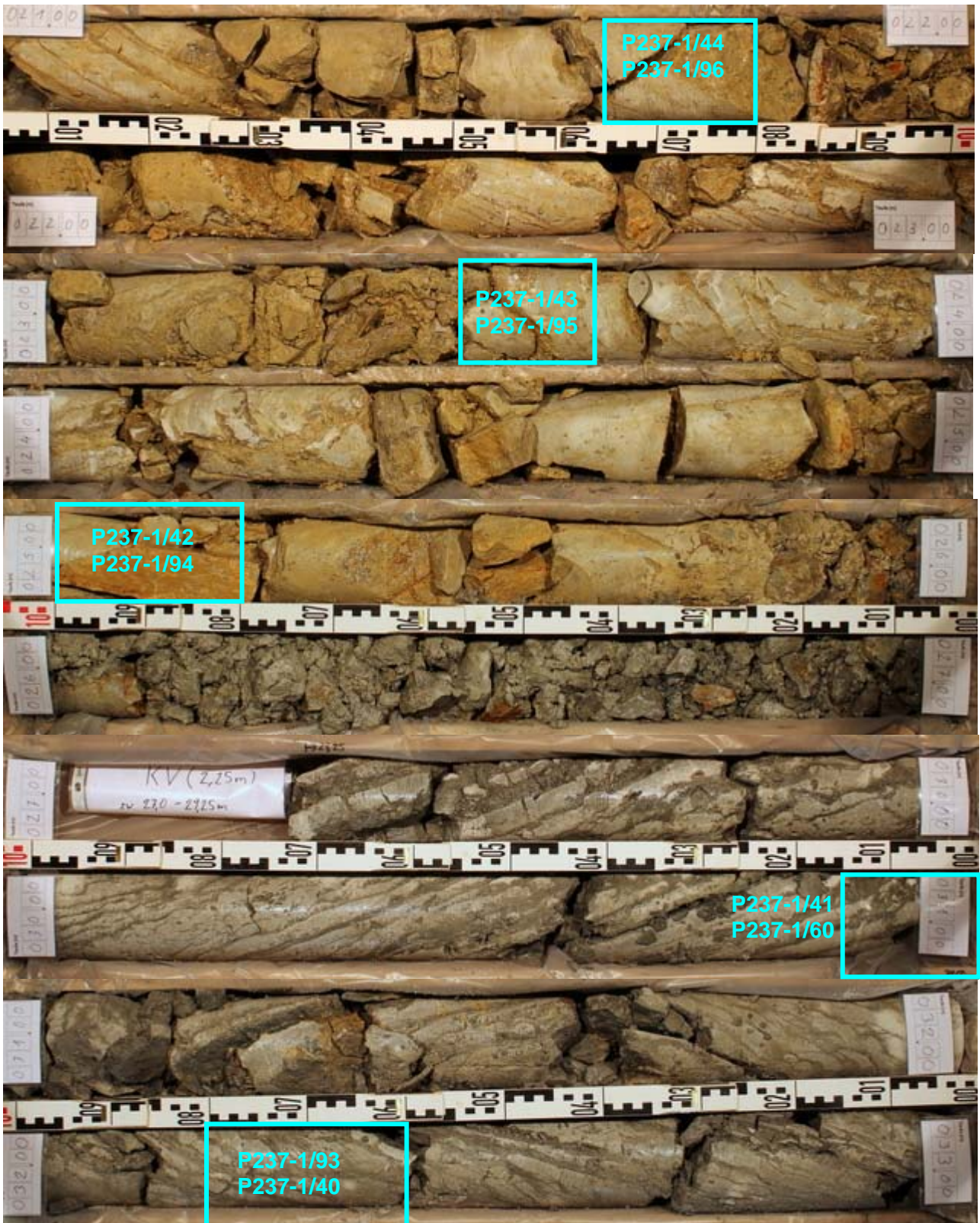
Abbildung A - 3 Probenahme im Bereich von 21 m v. AP – 33 m v. AP
