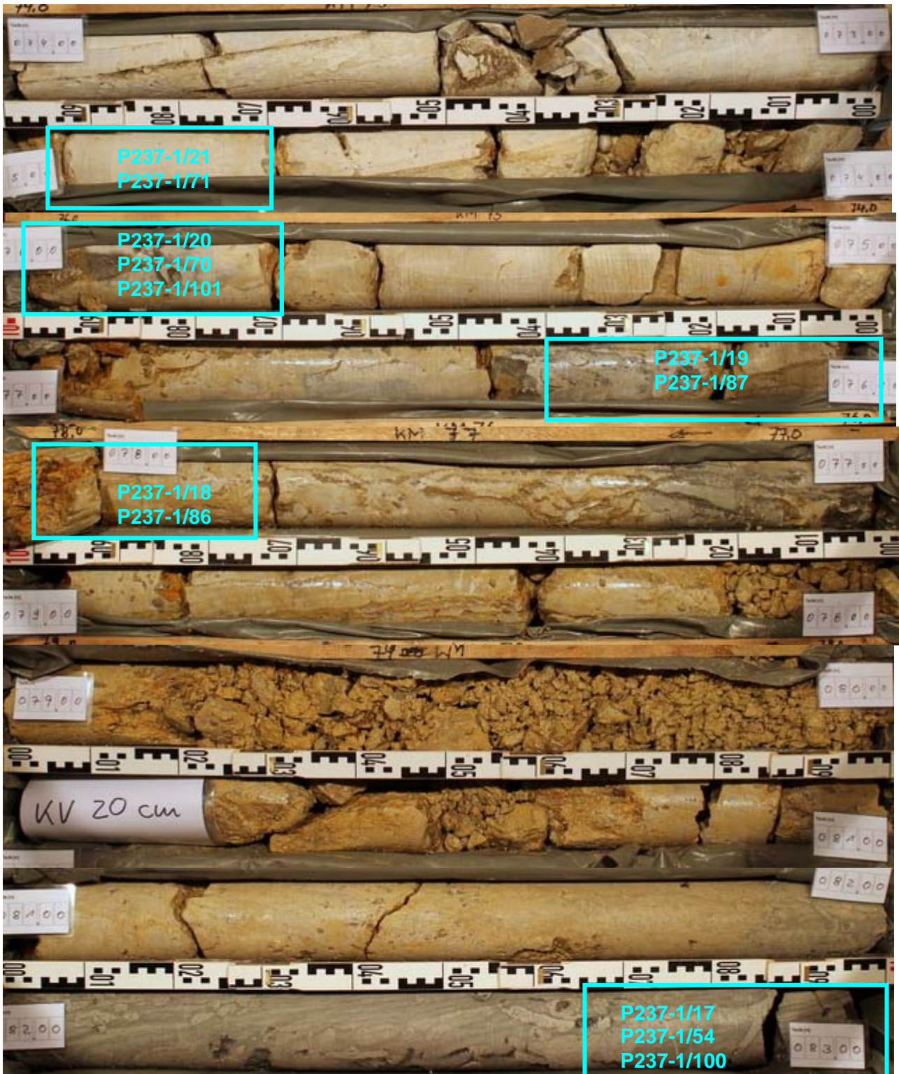
Abbildung A - 8 Probenahme im Bereich von 73 m v. AP – 83 m v. AP
