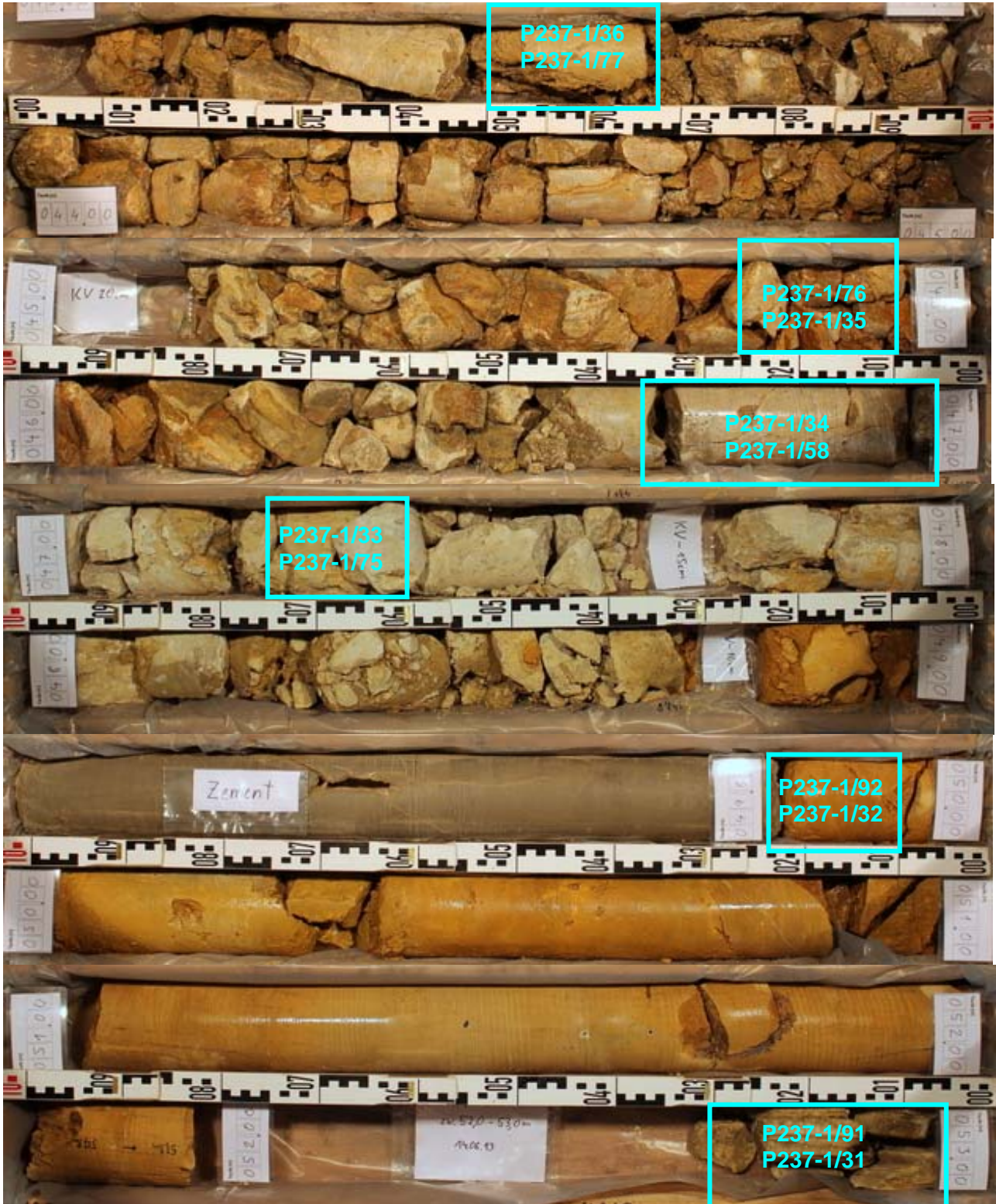
Abbildung A - 5 Probenahme im Bereich von 43 m v. AP – 53 m v. AP
