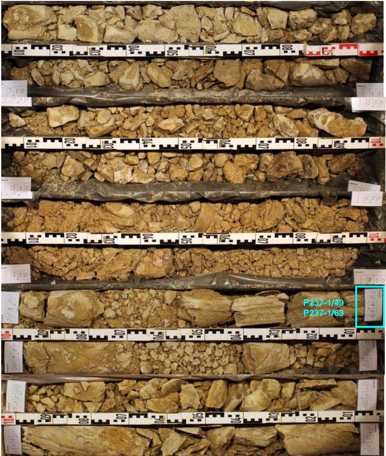
Abbildung A - 1 Probenahme im Bereich von 3 m v. AP – 12 m v. AP
