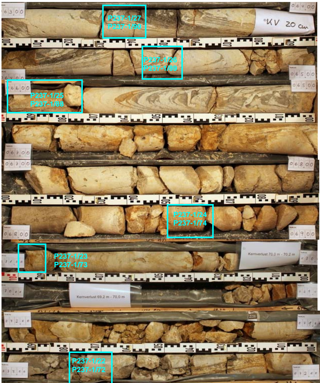
Abbildung A - 7 Probenahme im Bereich von 63 m v. AP – 73 m v. AP
