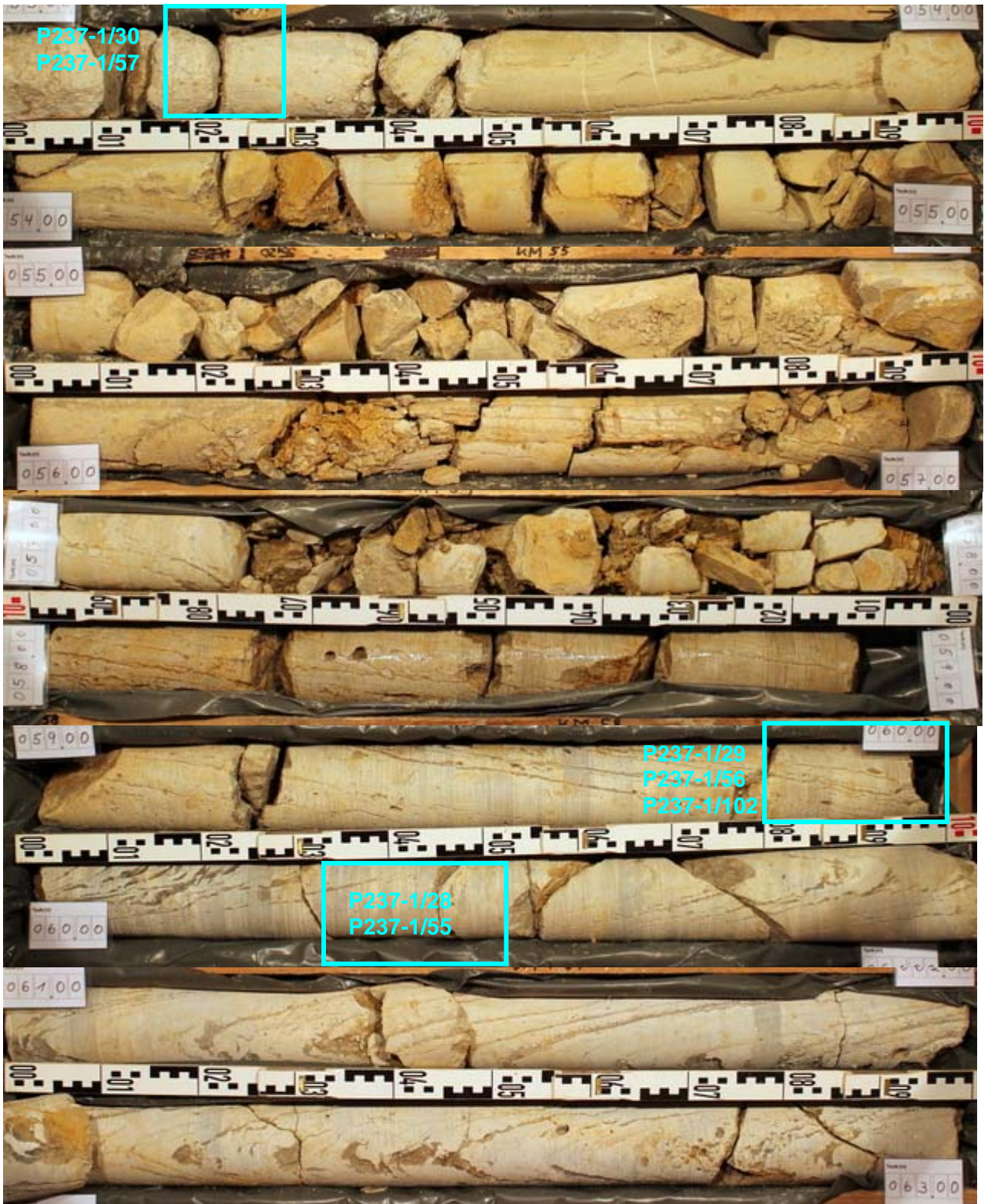
Abbildung A - 6 Probenahme im Bereich von 53 m v. AP – 63 m v. AP
