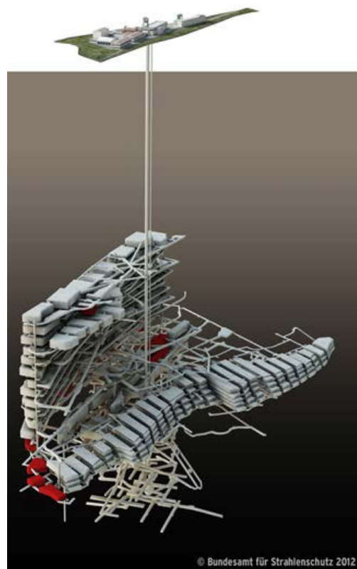
Abbildung 1: 3-D-Ansicht der Schachanlage Asse II; Blickrichtung von NO nach SW [8] (rot sind die ELK dargestellt)
