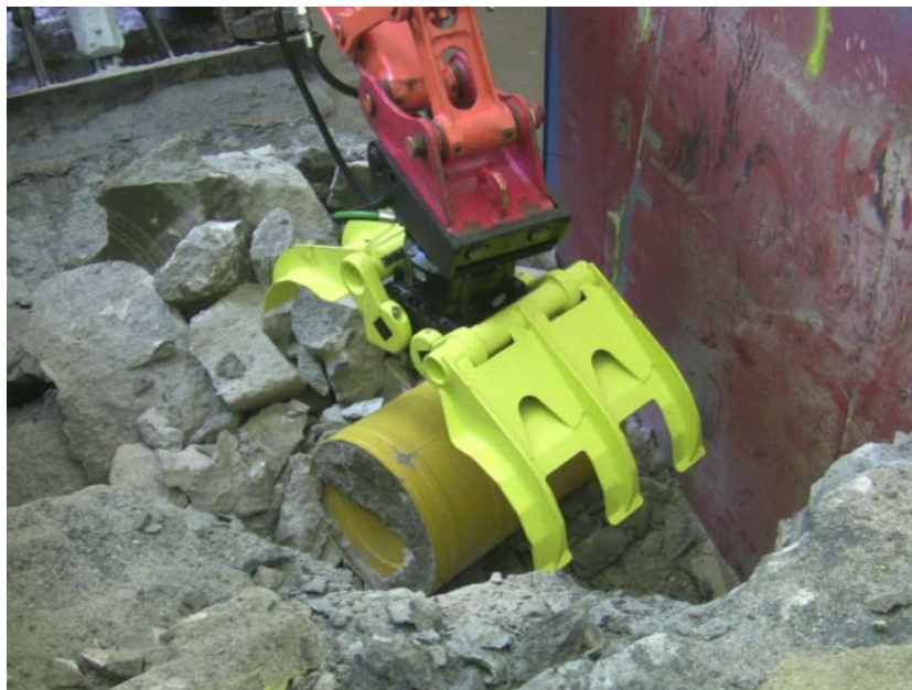
Abbildung 46: Versuche mit Nukleargreifer zum Greifen und Anheben von Gebinden [56]
