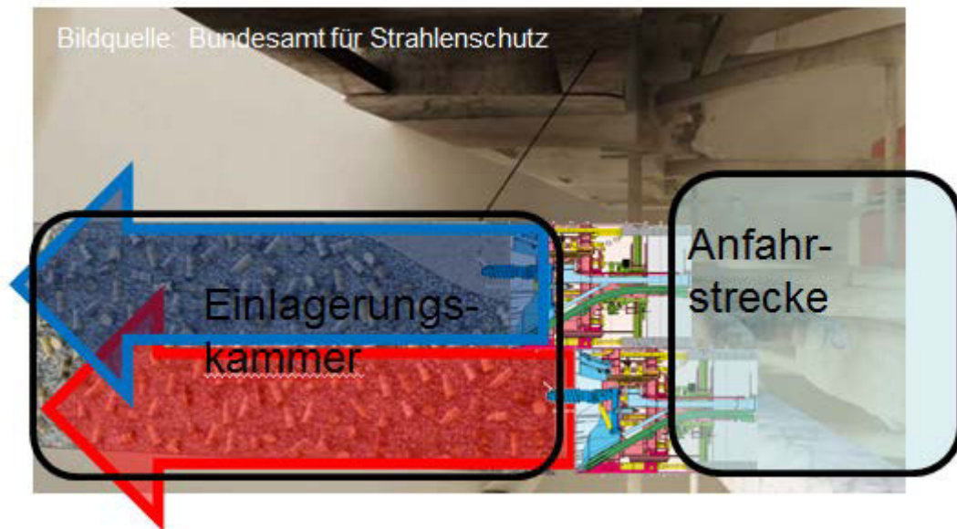
Abbildung 32: Vortriebsvariante II b: Längsschnitt der Auffahrestrecke für Schildvortrieb, Bildquelle BfS modifiziert durch Verfasser
