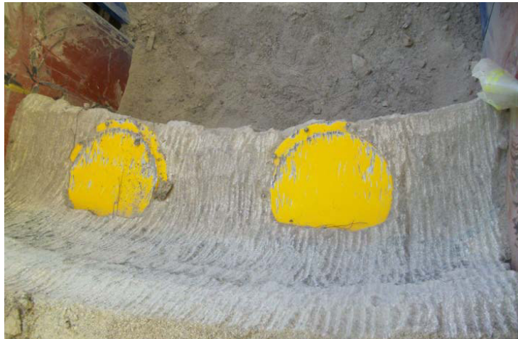
Abbildung 44: Fräsversuche zum Freilegen von Gebinden in Steinsalzbeton [56]
