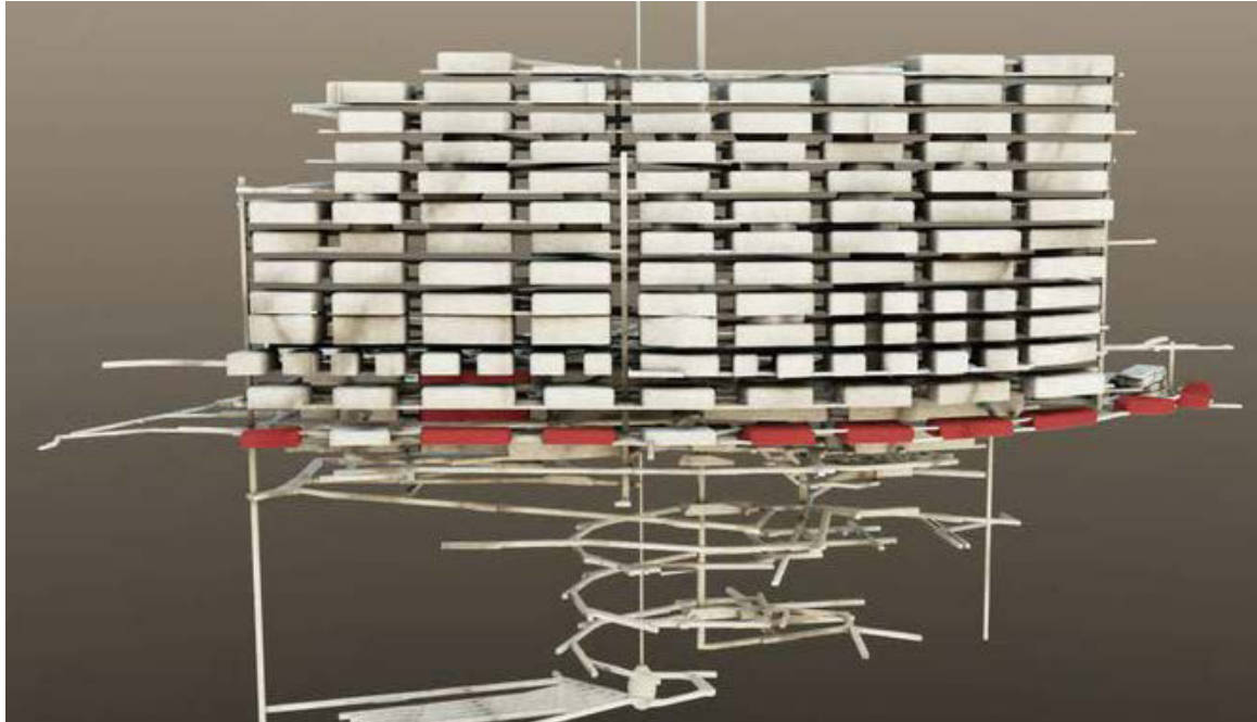
Abbildung 2: 3-D-Ansicht der Schachtanlage Asse II mit Einlagerungsbereichen (rot); Blickrichtung von S nach N [9] (rot sind die ELK dargestellt)
