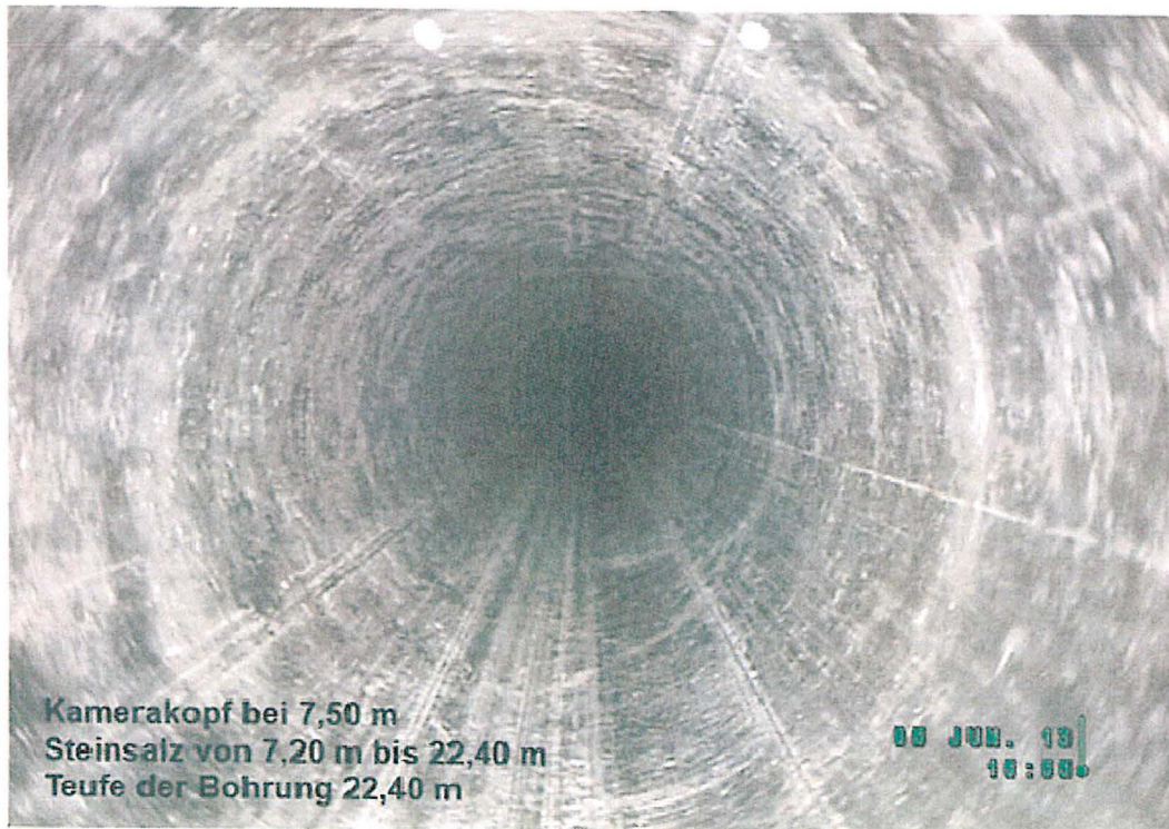
Abbildung 9: Bohrloch im Bereich des Messintervalls – Teufenangaben bezogen auf Kontur (nicht Standrohr)
