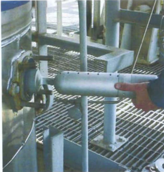
INSPEKTION VON FILTERBÖDEN IN GLAS-AUSGEKLEIDETEN BEHÄLTERN
