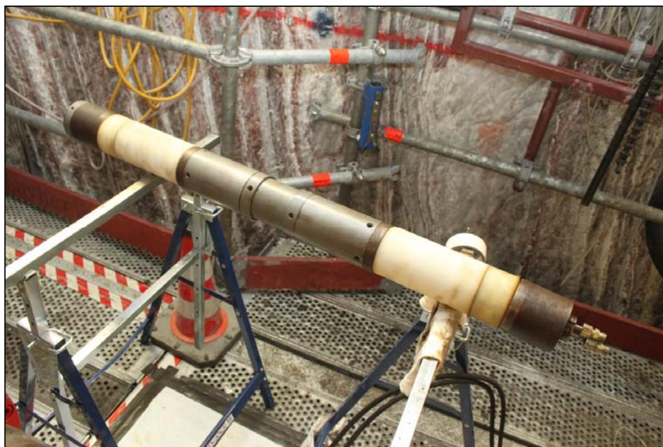
Abbildung 20: Messsonde der Fa. IfG zur Spannungssondierung
