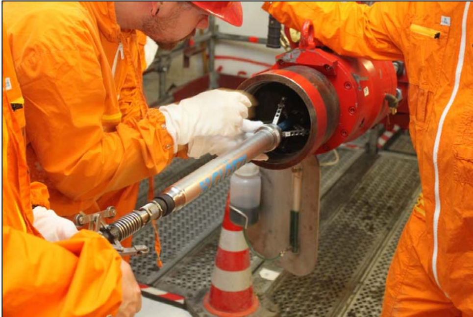
Abbildung 18: Einführen des Kalibermoduls in den Preventerstack
