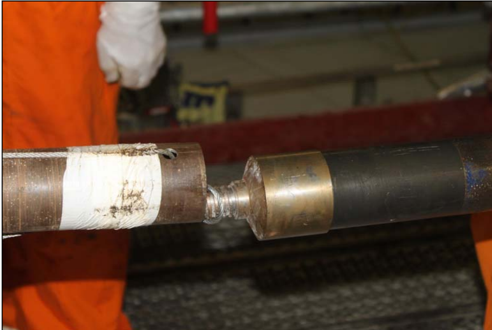
Abbildung 11: Fangvorrichtung mit Sonde nach erfolgreicher Bergung
