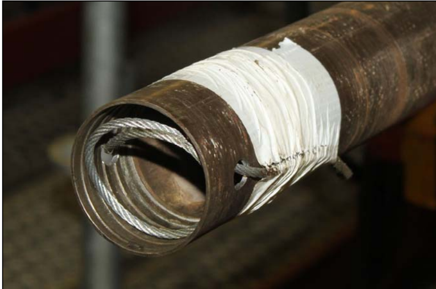
Abbildung 9: Fangvorrichtung (NQ-Gestänge mit Stahldrahtschlinge) zum Fangen der abgedrehten GRS-Messsonde
