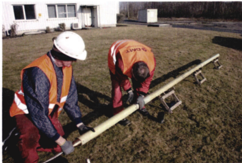
Abbildung 28: Zusammengebaute richtungssensitive 3D-Bohrlochradarsonde 85
