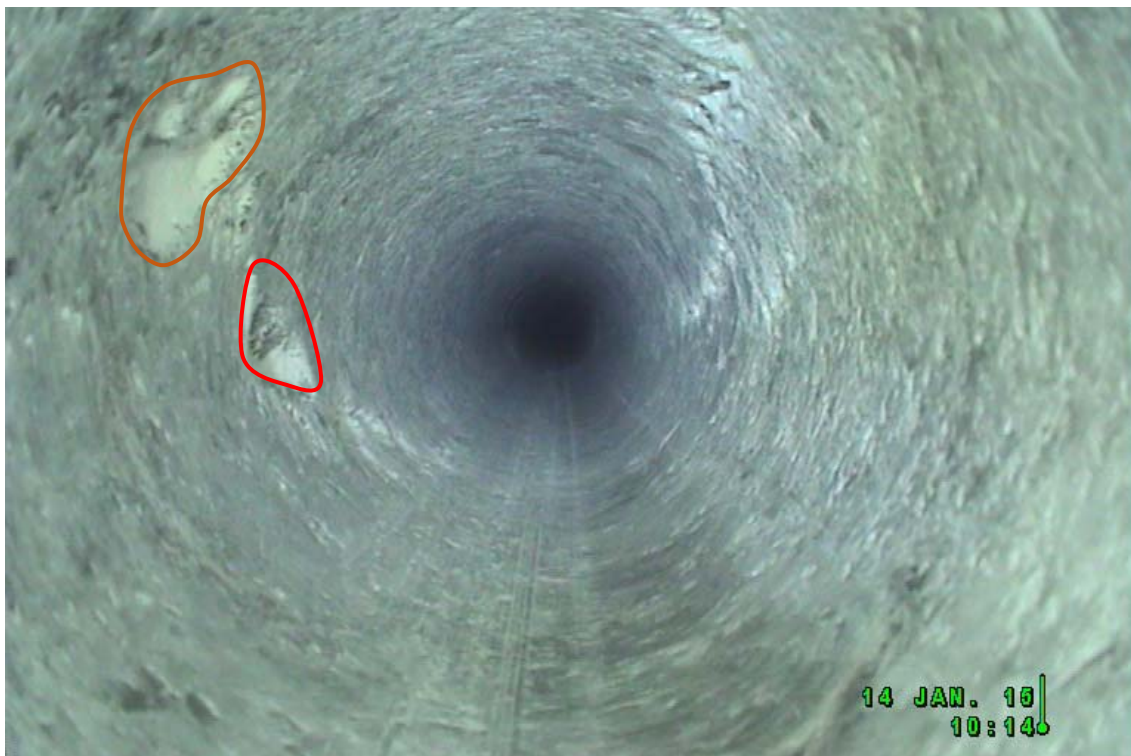
Abbildung 20: Position des Kamerakopfs bei 37,60 m, offene Kluft mit Gefügeöffnung bei 37,70 m (brauner Umriss) und 37,80 m (roter Umriss) aufgeschlossen
