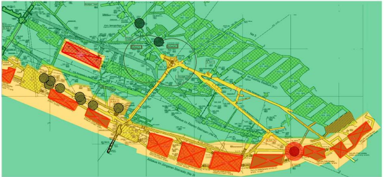
Abbildung 135: Sohlenriss der 750 m Sohle mit Verdachtsflächen (gelb), kontaminierten Bereichen (rot), nicht kontaminierten Bereichen (grün) sowie Fassstellen von Zutrittswässern (Kreise) [3]
