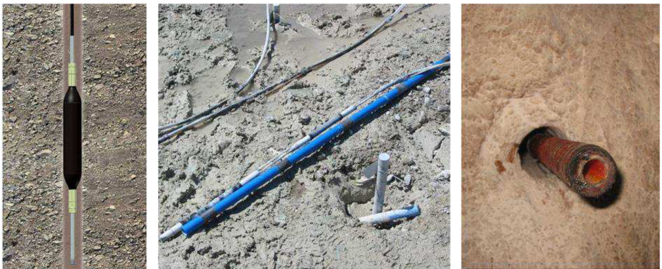
Abbildung 40: Beispiele für Injektionszubehör: Blähpacker im offenen Bohrloch (links, Quelle: Desoi GmbH), Manschettenrohr (Mitte, Quelle: Züblin AG), Hohlstabanker in GFK-Ausführung (rechts, Quelle: Redpath Deilmann GmbH)
