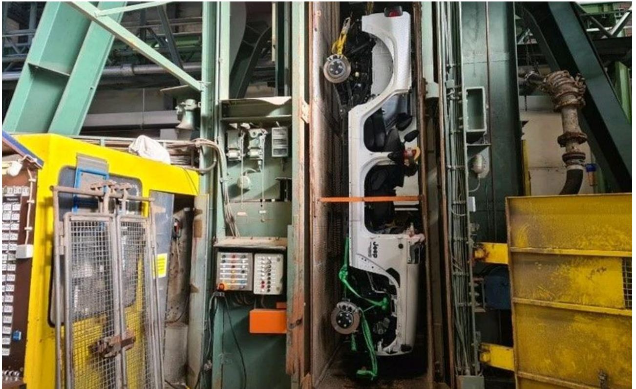
Abbildung 59: Beispielhafter Schachttransport im Schacht Asse 2 (Quelle: BGE)
