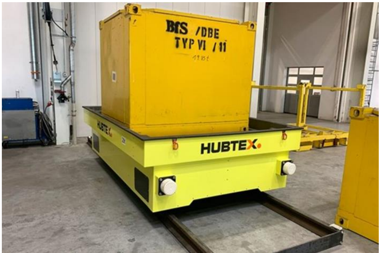
Abbildung 89: Beispiel Plateauwagen beladen mit einem Konrad-Container [Quelle: BGE]
