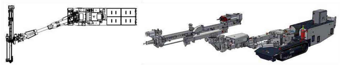
Abbildung 39: Beispiel eines untertagegängigen Bohrwagens mit schwenkbarer Lafette (Quelle: dh Mining Systems)
