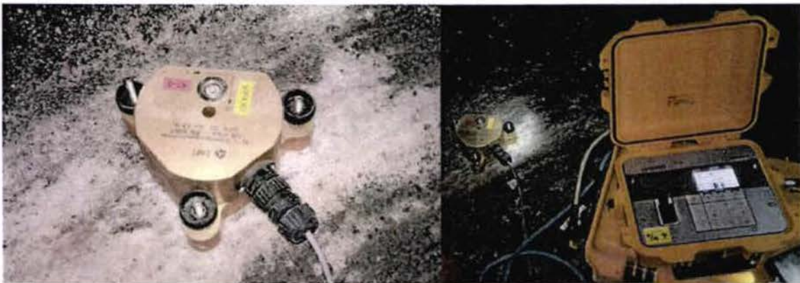
Abbildung 13: Installation von Sensor (links) und Messequipment (rechts) am Standort "S637M"
