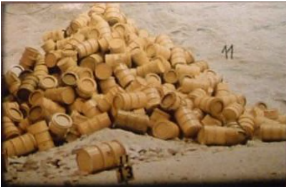
Abbildung 3: Versturzkegel der Abfallgebände in der MAW-Kammer nach der Einlagerung, aus [13].
