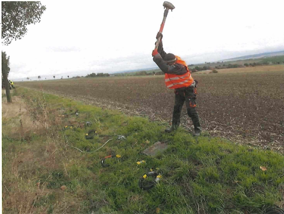
Abbildung 4: Hammerschlag als seismische Quelle
