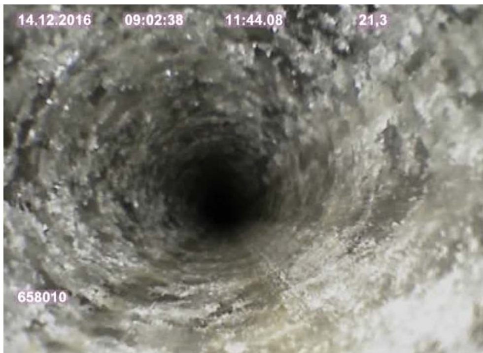
Foto 11h: Bohrung feucht bei 21,30 m
