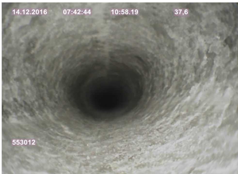
Foto 2f: Bohrung bei 37,60 m, elliptisch und leicht porös
