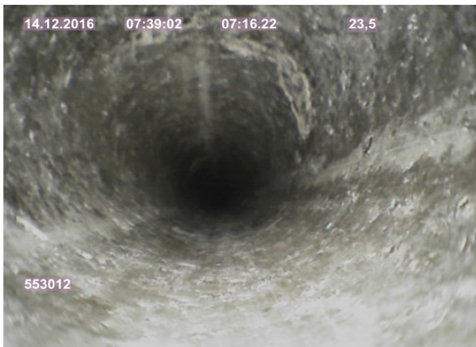
Foto 2e: Bohrung bei 23,50 m, trocken und leicht porös
