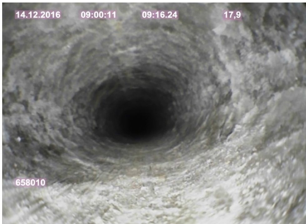
Foto 11g: Bohrlochwand porös und elliptisch bei 17,90 m
