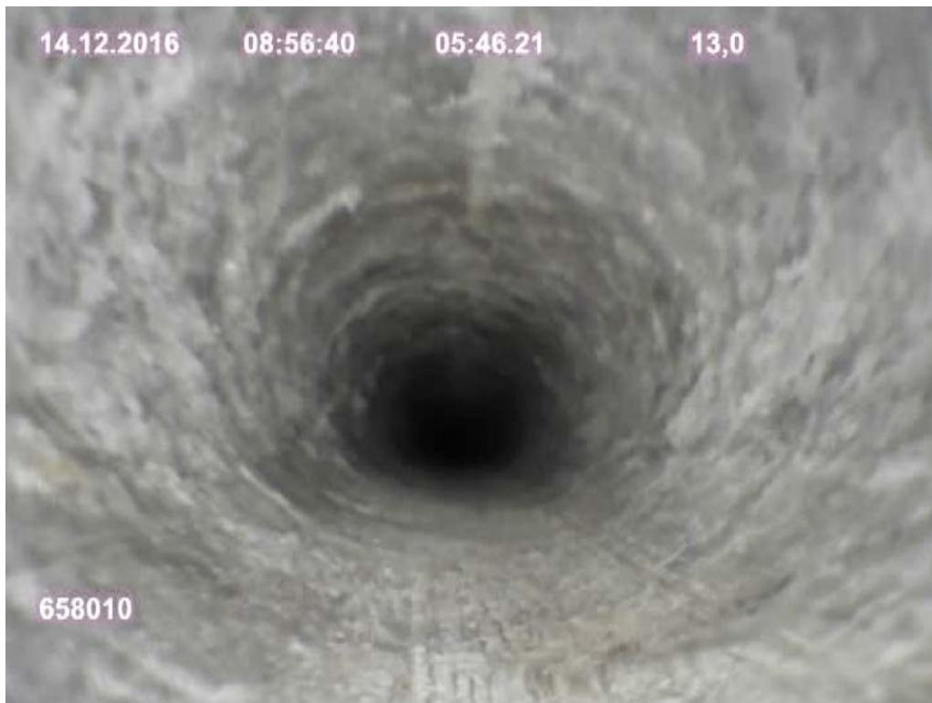
Foto 11d: Bohrlochwand porös und elliptisch bei 13,00 m
