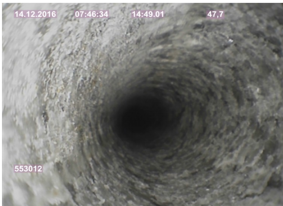
Foto 2h: Bohrloch leicht konvergiert bei 47,70 m
