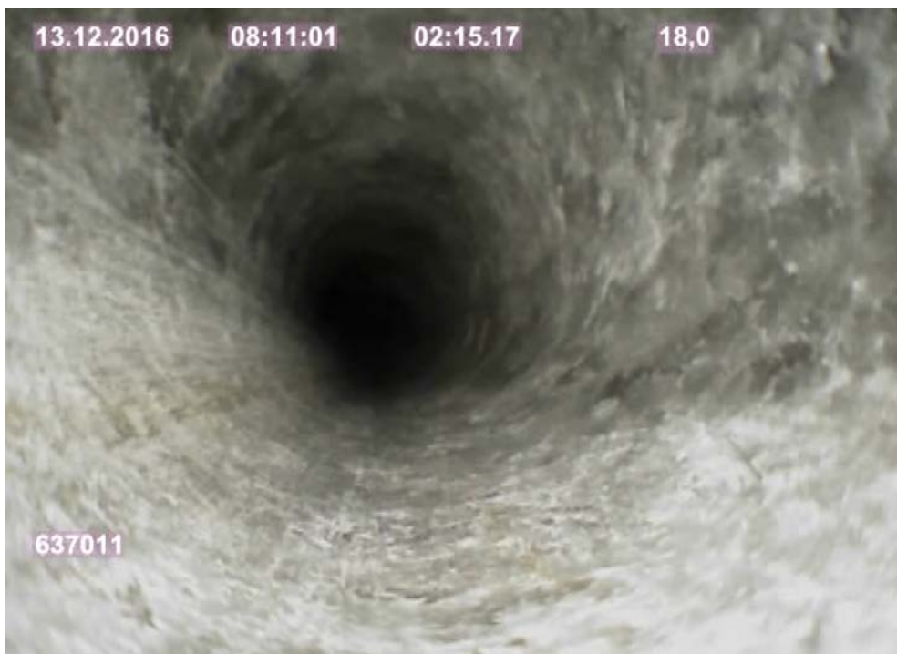
Foto 10b: Bohrloch bei 18,00 m, leicht porös
