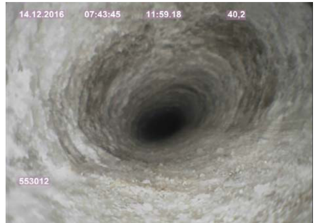
(b) Beanspruchter Bereich mit elliptisch verformtem Bohrlochquerschnitt
