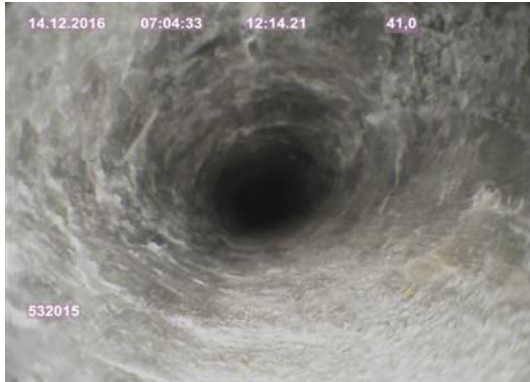
Bild 1: Bohrung 532015; elliptische Bohrlochkontur bei 41 m Bohrlochteufe; Aufnahme vom 14.12.2016
