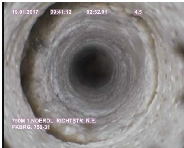
Bild 44: FKBrG. 750-31 – Position bei ca. 4,6 m Übergang Sorelbeton–Steinsalz mit Firstspalt, Öffnungsweite ca. 8 mm
