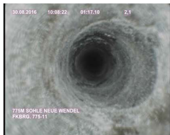
Bild 12: Beanspruchung mit angedeutetem potentiellen Riss (FKBrG.775-11, Teufe: 2,10 m)
