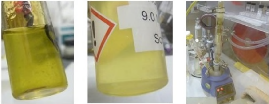
Abb. 12: Aufarbeitung von 25 mg Pa 2 O 5 (s). Links) Auflösen in 8 mol L -1 HNO 3 , Mitte) zusätzliche Zugabe von 9,0 mol·L -1 HCl und 0,1 mol·L -1 HF, Rechts) Rückflussapparatur zur Entfernung von NO x und HF
