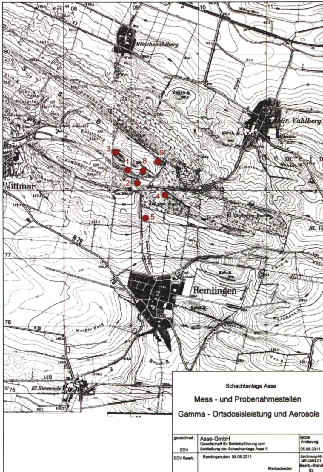
Abbildung 6: Mess- und Probenahmestellen für Gamma-Strahlung und Aerosole
