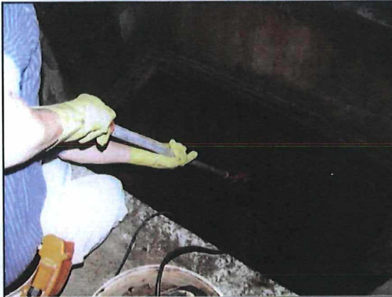
Photo 25: Probenahme aus Laugensammlung in Sohlenschlitz MP_QN mit Schöpfer
