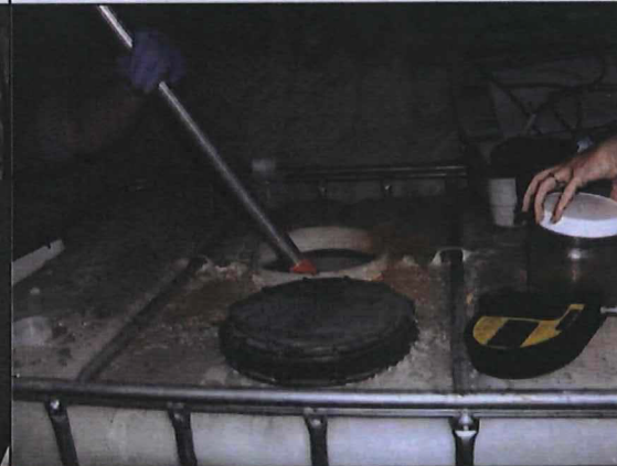
Photo 16: Messung von Dichte, Temperatur, Leitfähigkeit und pH an MP RL1
