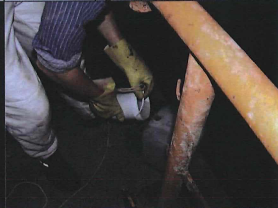
Photo 04: Probenahme am MP_WPB mit Schöpfgefäß
