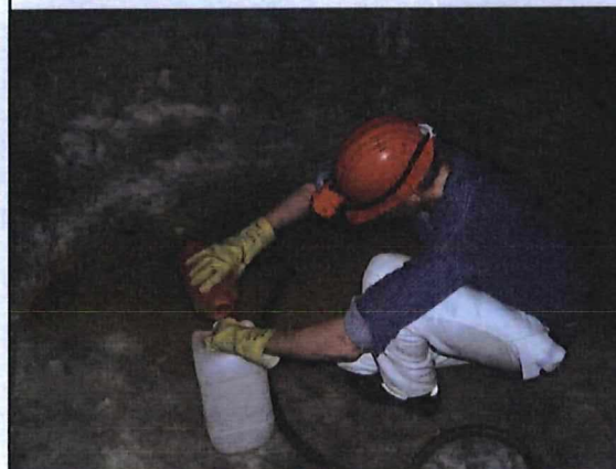
Photo 11: Füllen eines Probebehälters 10-Liter am Laugesumpf vor Kammer 4
