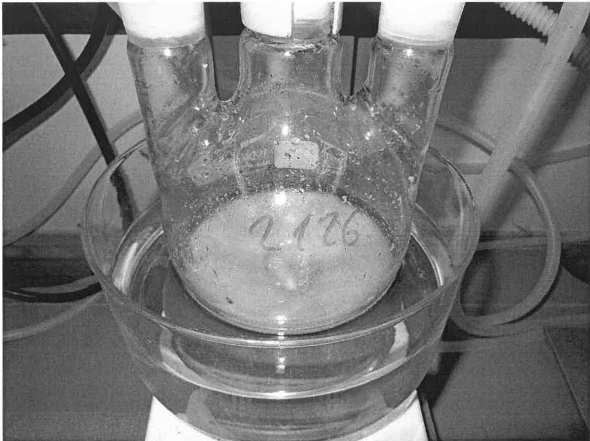
Abbildung 1d:: Probenlösung nach Zugabe von HCl zur Freisetzung von ^{14}\text{CO}_2 aus Karbonat bei ausgewählter Probe. Hier: „P750041“ (URA-Code# 1002126) (Aufnahme: [REDACTED], 02.07.2015).
