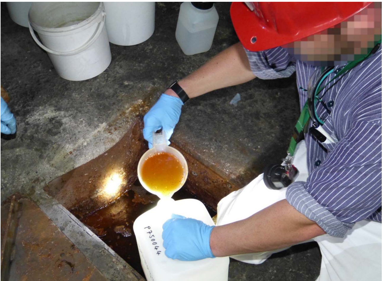
Abbildung 9: Probenahme an der Messstelle P750044 vor dem westlichen Zugang zu der Einlagekammer 8 auf der 750-m-Sohle.
