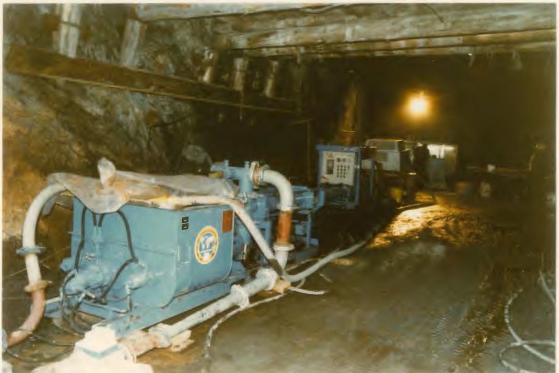
2. Versuchsstand mit Mischer und Doppelkolbenpumpe
