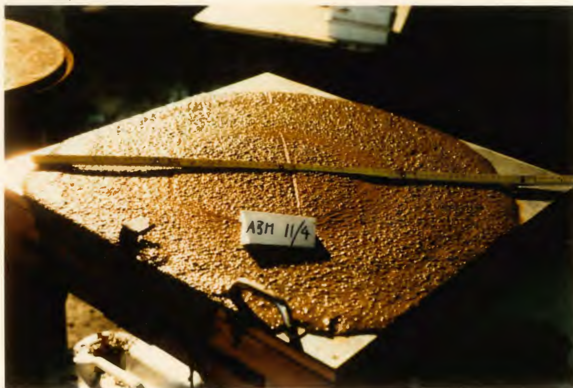
20. Versuch II - Ausbreitmaß 4
