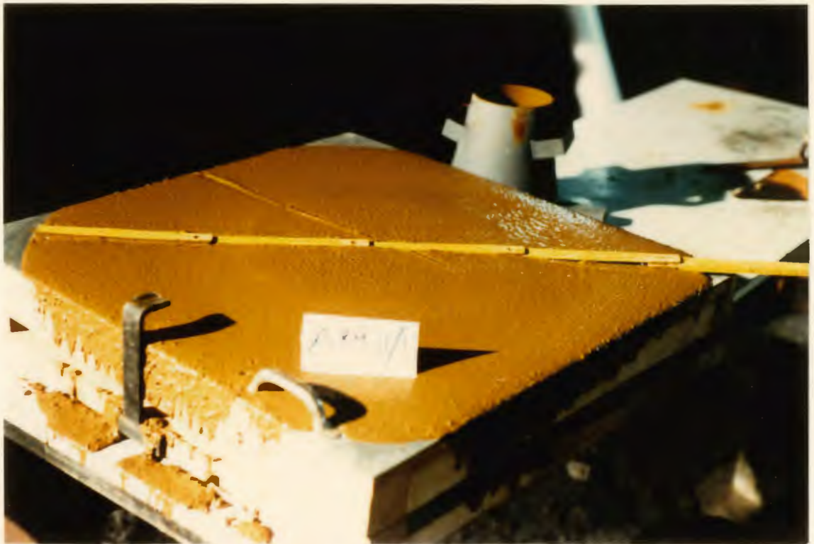
17. Versuch II - Ausbreitmaß 1
