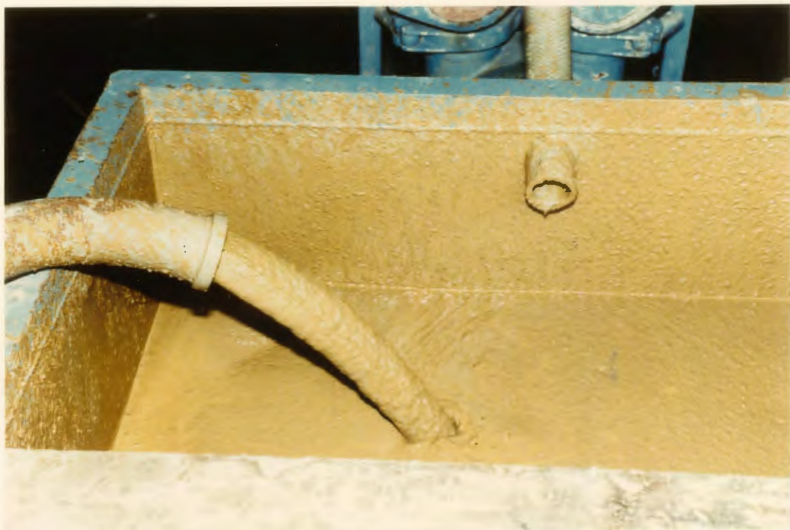
27. Rohraustrag in der Pumpenvorlage - Nebengestein
