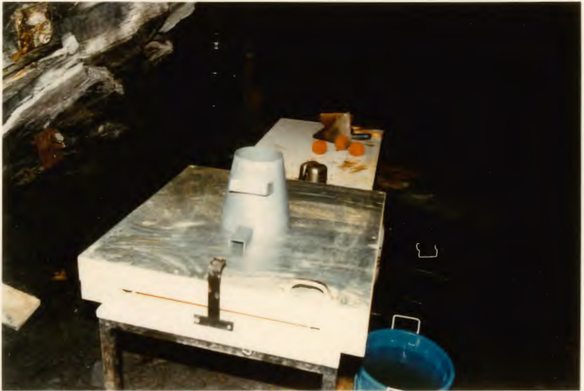
13. Ausbreitmaßtisch nach DIN
