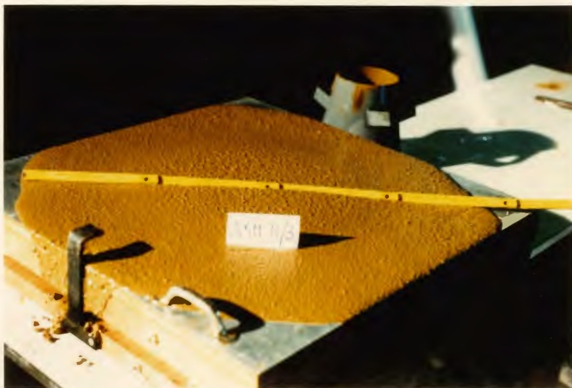
19. Versuch II - Ausbreitmaß 3
