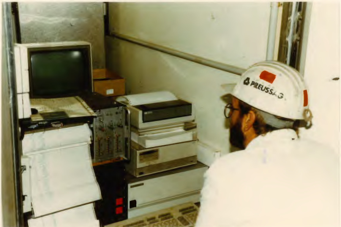
10. MSR - Datenaufnahme, -speicher und -auswertestation
