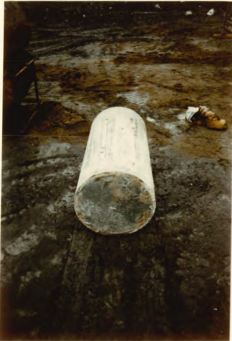
8. Ausgebautes vorderes Eternitrohr
