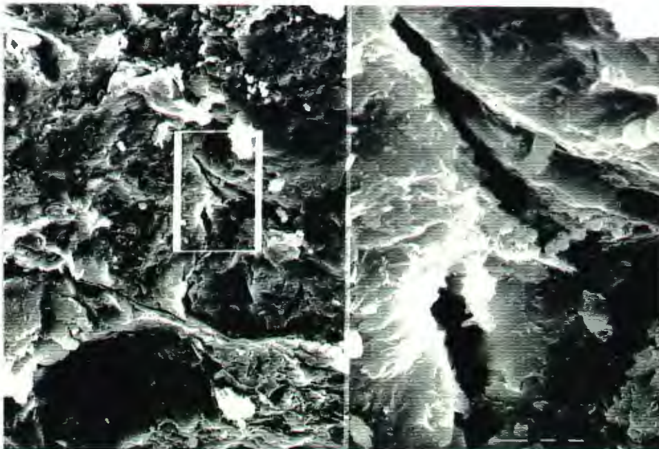
Abb. 18 380/1900-fache Vergrößerung Sekundäre Porosität entlang der Kornkontakte, von dort aus in die mergelige Matrix hineingehend. Porenkanäle z. T. mit Pyrit verfüllt. Quarzkörner sind mit Ton überzogen.
