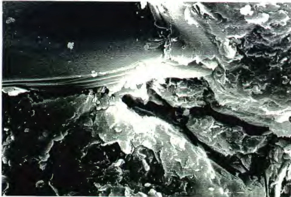
Abb. 16 1200-fache Vergrößerung Lösungsporosität in Form langer Porenkanäle zwischen Muskovit (oben links) und Quarz. Quarzkörner mit Ton-coating. Salzhaltige, mergelige Matrix (Ca, Si, Fe, Al, K, NaCl).
