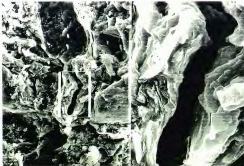
Abb. 24 300/1500-fache Vergrößerung Quarzkörner mit Ton- und Salzverunreinigungen. Ausgeprägte sekundäre Porosität in Tonmergel-Lagen. Linke Porenwandung mit Tonen belegt (Si, Al, Fe, K, Mg); rechte Porenwand versalzen.
