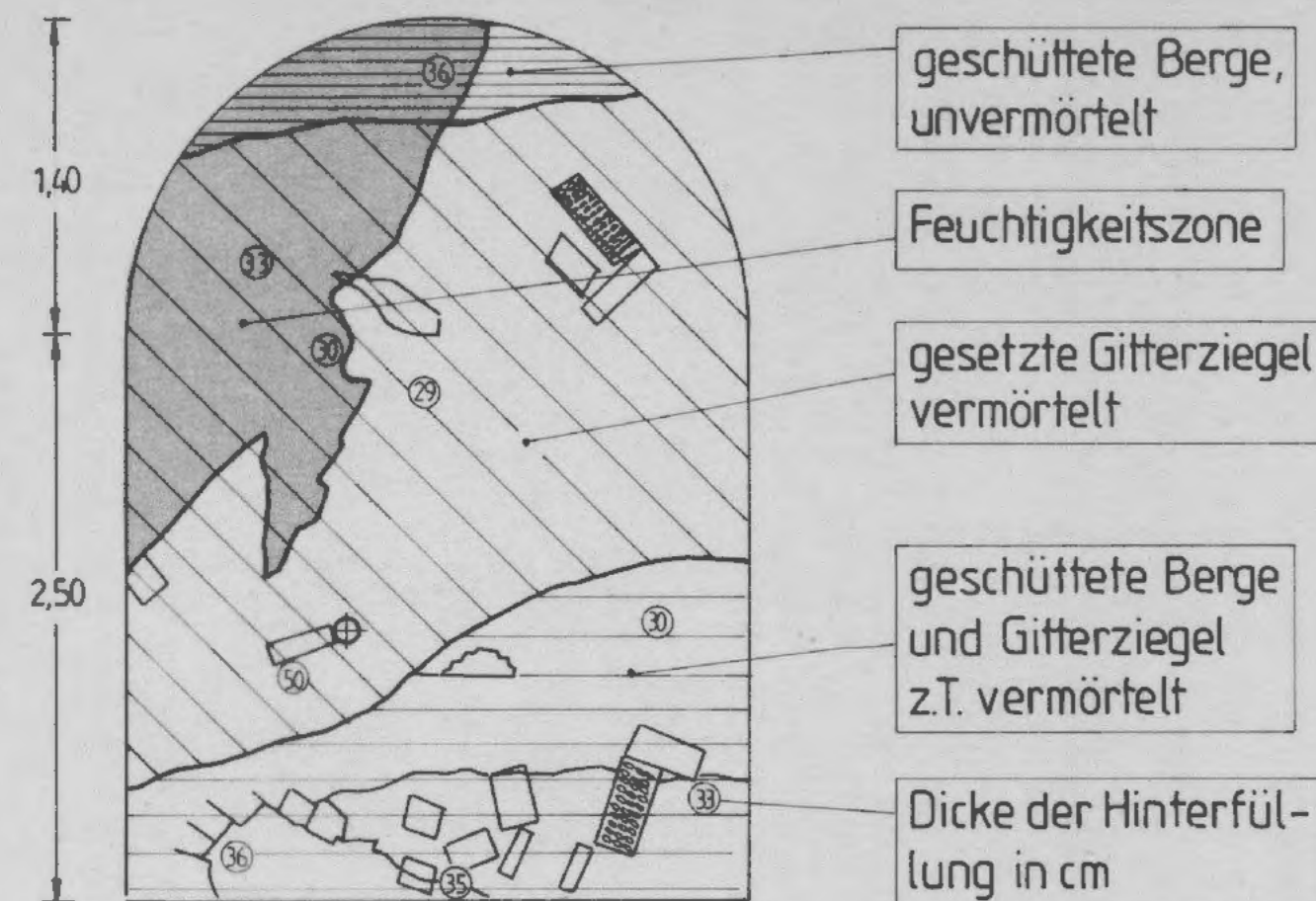
Station 0,0m (Ausbauhinterfüllung)
