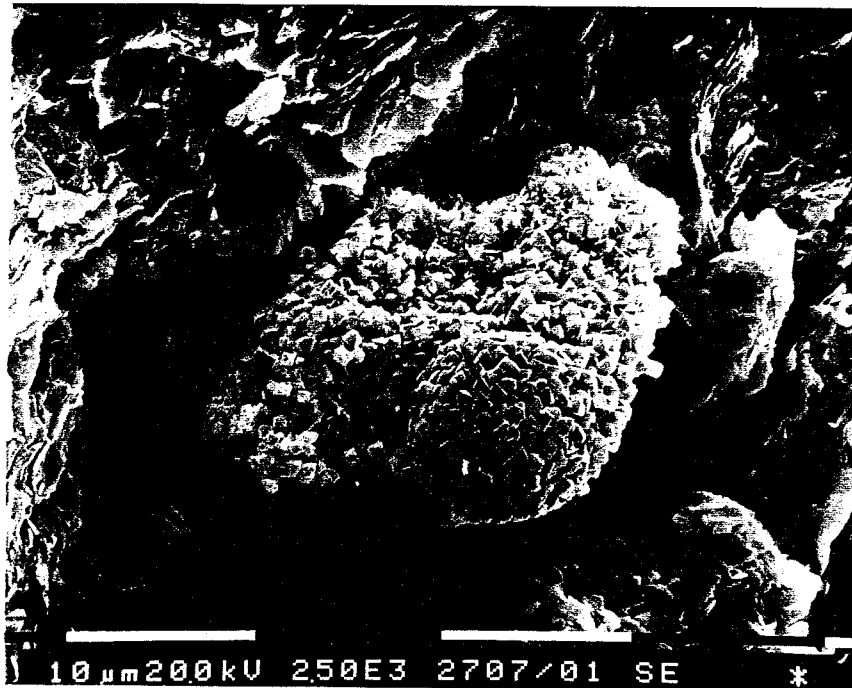
Fig. R2 Himbeerpyrit auf Pyritnest in toniger Umgebung, schlierig - unregelmäßiges Gefüge. Feine Gipsnadelchen ? Bohrung 10/13.30 m Strecke - ()
