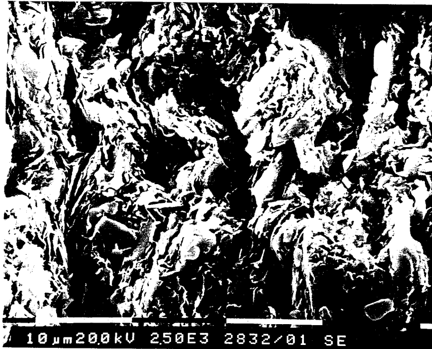
Fig. R15 Übersicht: schlieriges bioturbates Tongefüge mit Coccolithen. Bohrung 11/39.90 m Strecke - ( )
