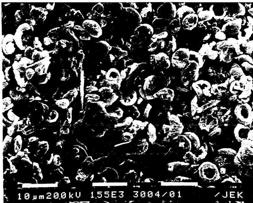
Fig. R21 Übersicht von der Fraktion 2 - 6.3 μ. Vorwiegend Coccolithen-Detritus, Glimmerplättchen. Bohrung 10/13.30 m Strecke
