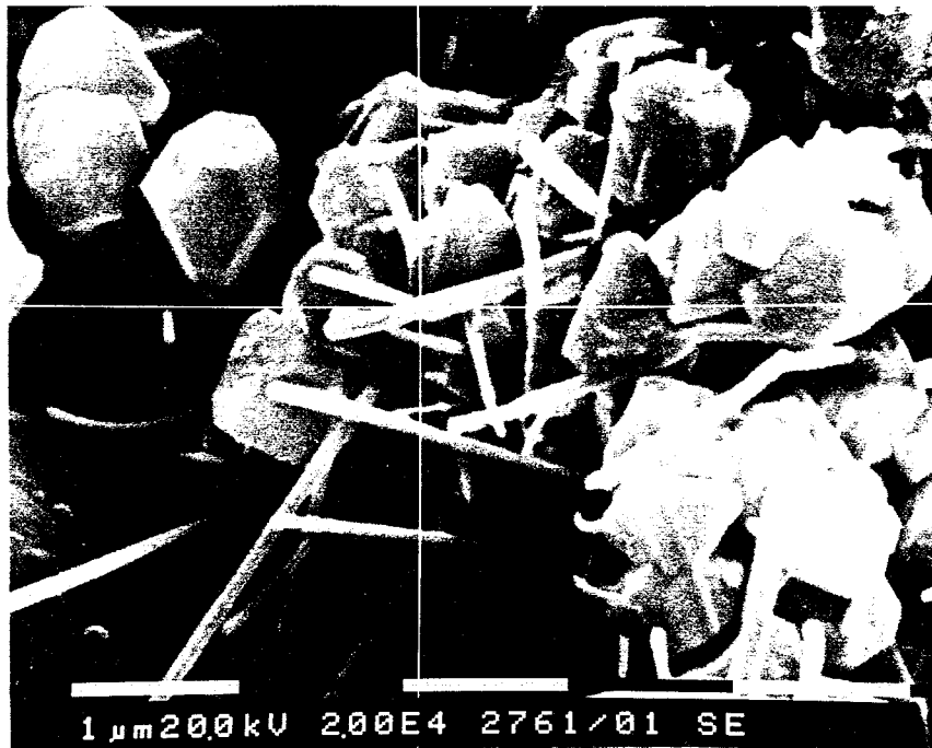
Fig. R8 Pyritkristalle z. T. mit Lösungserscheinungen. Gipsnadelchen als Reaktionsneubildungen zwischen Pyrit und Calcit ? Bohrung 10/13.30 m Strecke - (=)
