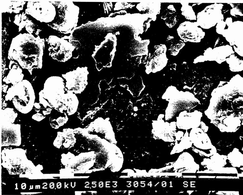
Fig. R27 Übersicht der Fraktion 2 - 6.3 µm mit Coccolithen-Detritus und angelöstes Glimmerplättchen (Al, Si, K und Fe mit EDX nachgewiesen). Bohrung 11/3.44 m Strecke
