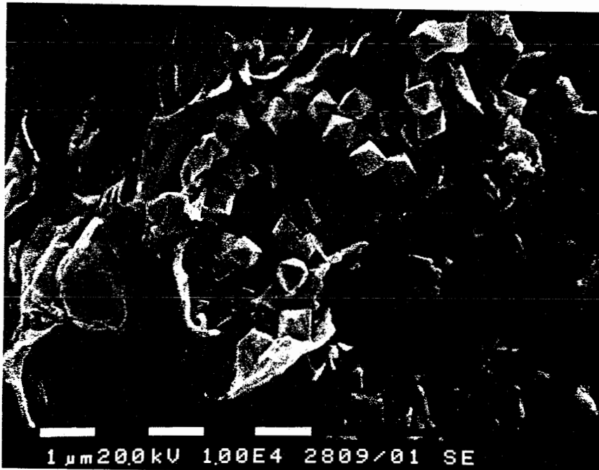
Fig. R13 framboidisches Pyritaggregat Bohrung 11/3.44 m Strecke - ()
