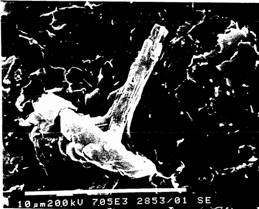
Fig. R20 Gut erhaltener Coccolith umgeben von Smektit Bohrung 11/39.90 m Strecke - (=)
