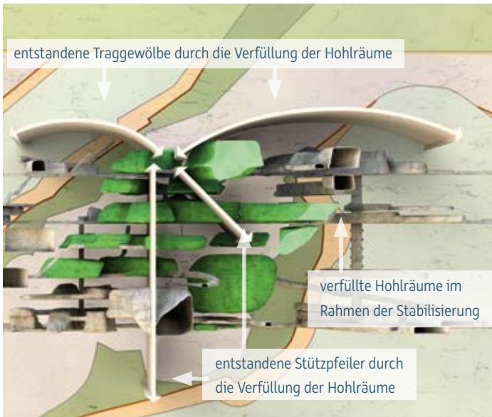
Schematische Darstellung der Stabilisierungswirkung der Verfüllmaßnahmen
