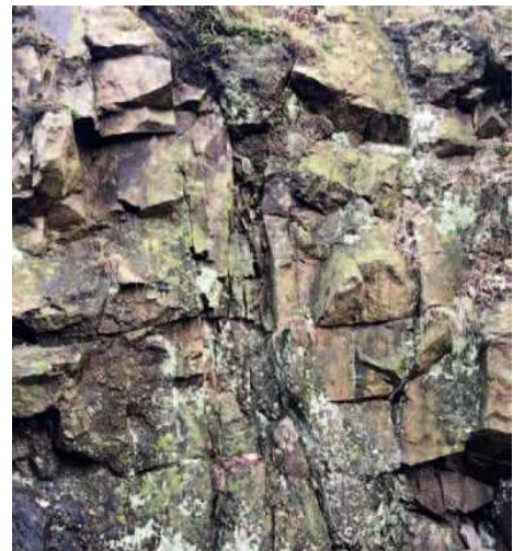
Abb. 13: Granitaufschluß an der südlichen Seite der Schlierbacher Landstraße (B 37) im Stadtteil Schlierbach. Enge Zerteilung des Gesteins und deutliche Störungsflächen. (Nr. 6 in Abb. 7).
