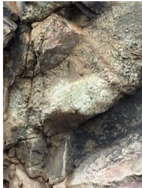
Abb. 8: Granitaufschluß an der nördlichen Seite der Scheffelstraße im Stadtteil Neuenheim. Enge Zerteilung des Gesteins und deutliche Verwitterung. (Nr. 1 in Abb. 7).
