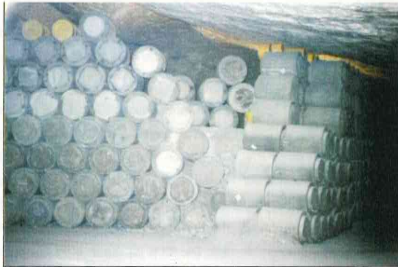
Abbildung 15: ELK 7/750, gestapelte verlorene Betonabschirmung (VBA) Archiv Nr.: e 223, Aufnahme vom 27.10.1977
