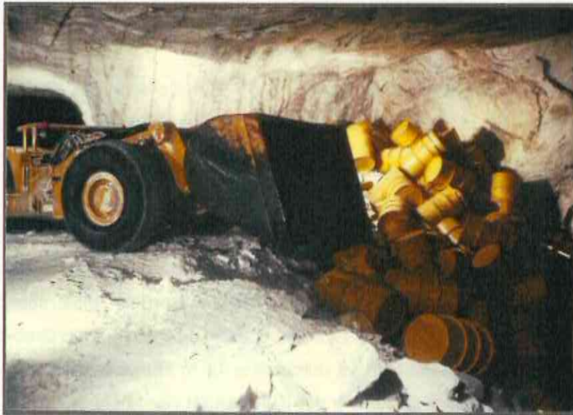
Abbildung 3: ELK 8/750, Schaufellader beim Abkippen der Fässer Archiv Nr.: C 396; Aufnahme vom 08.01.1975
