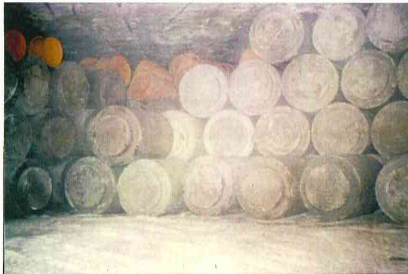
Abbildung 16: ELK 11/750, gestapelte VBA und sonstige Gebinde oberhalb der eingebrachten Ausgleichsschicht zwischen den unteren gekippten Fässern und den oberen gestapelten Fässern Archiv Nr.: e 217; Aufnahme vom 27.10.1977
