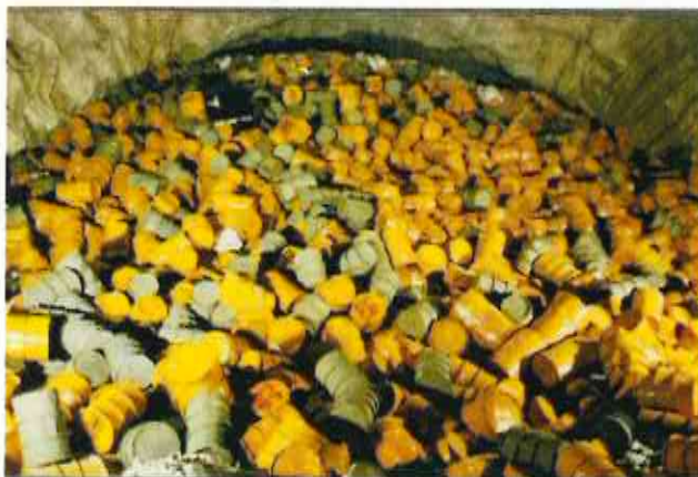
Abbildung 3: Einlagerungskammer 2/750 (Na2), schwachradioaktive Abfälle Archiv Nr.: c 707; Aufnahmedatum unbekannt
