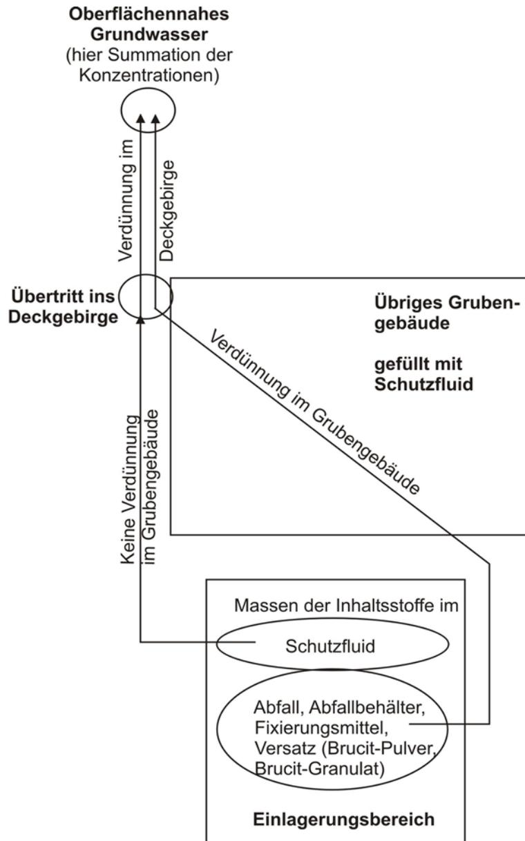
Abbildung 4-1: Schematische Darstellung der rechnerischen Verdünnung der Konzentrationen der Wasserinhaltsstoffe im Grubengebäude und oberflächennahes Grundwasser.
