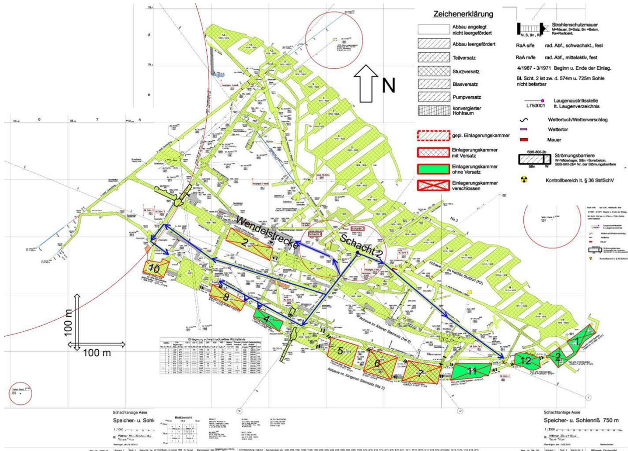
Abbildung 5: Sohlenriss 750-m-Sohle; ELK und Zugangsbereiche entsprechend Risswerk [12] bis [14]; modifiziert durch Verfasser
