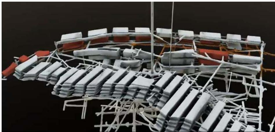
Abbildung 3: 3-D-Ansicht des Einlagerungsbereichs auf der 725-m- und der 750-m-Sohle; Blickrichtung von N nach S [9] (rot sind die ELK dargestellt)
