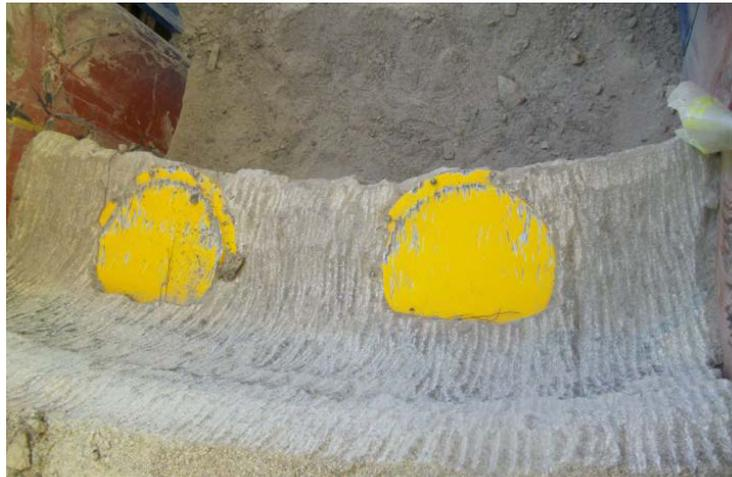
Abbildung 44: Fräsversuche zum Freilegen von Gebinden in Steinsalzbeton [56]
