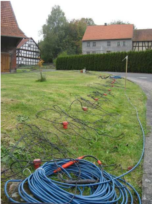
Abbildung 4: An die Messauslage angeschlossene Geophone empfangen die seismischen Signale (links). An einem Empfangspunkt ausgelegte Geophongruppe aus 12 Geophonen (rechts).
