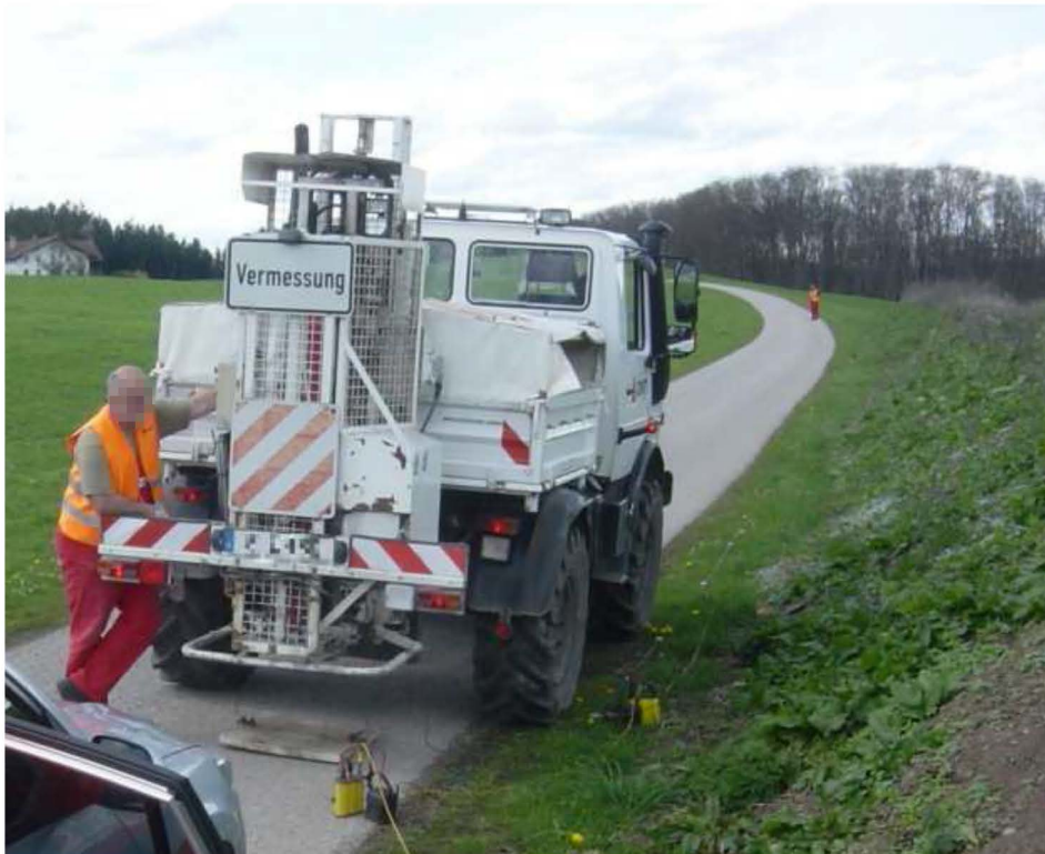
Abbildung 3: Nahlinienmessung mit einem beschleunigten Fallgewicht als Quelle.
