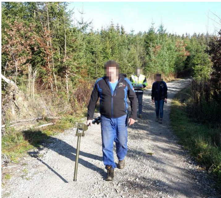
Abbildung 2: Kampfmittelsondierung mit einem Fluxgate-Magnetometer.
