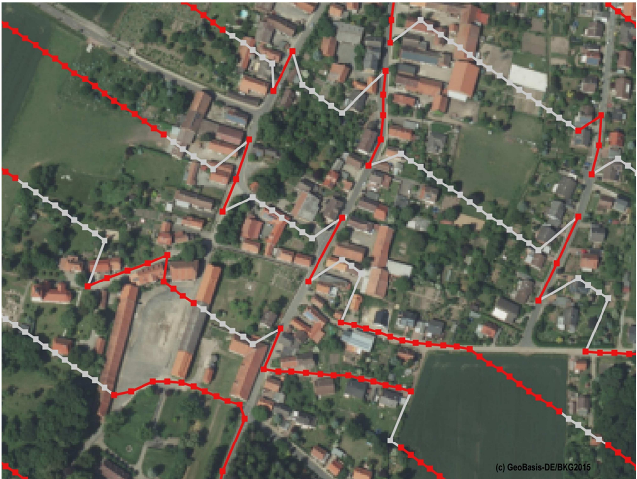
Abbildung 15: Simulation der Verlegung und des Ausfalls von Anregungspunkten bei dichter Bebauung am Beispiel Groß Vahlberg. Ausfallende Anregungspunkte sind weiß markiert.
