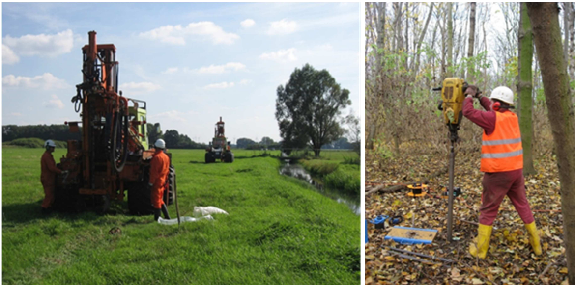
Abbildung 10: Bohrgeräte auf MB-Tracs (links) und Handbohrgerät im Einsatz (rechts) .
