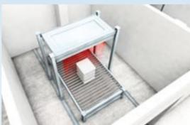
Die in den Overpacks befindlichen Abfälle müssen radiologisch untersucht werden. Hierzu werden die Overpacks in spezielle Messanlagen gestellt und der Inhalt mithilfe zerstörungsfreier Prüfungen bestimmt (charakterisiert). Sofern möglich sollen die Overpacks nicht wieder geöffnet und damit die Strahlenbelastungen minimiert werden. Die radiologische Charakterisierung ist wichtig für die spätere Endlagerung der Abfälle.
