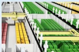
Nach der Konditionierung werden die Container gelagert, bis sie in ein aufnahmebereites Endlager transportiert werden können. Abfälle, die Kernbrennstoff enthalten, müssen in einem besonders gesicherten Bereich des Asse-Zwischenlagers verwahrt werden. Dieser erfüllt die Anforderungen an die Lagerung von Kernbrennstoffen. Bei den kernbrennstoffhaltigen Abfällen handelt es sich nach bisherigen Erkenntnissen nicht um hochradioaktive Abfälle.
