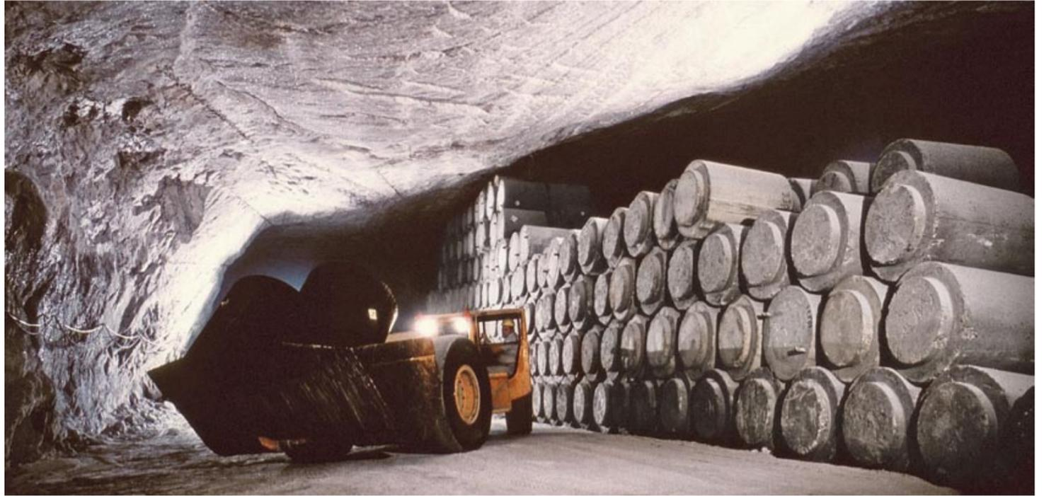
EINE EINLAGERUNGSKAMMER, IN DER DIE ABFALLFÄSSER MIT EINER SOGENANNTEN VERLORENEN BETONABSCHIRMUNG GESTAPELT WURDEN
