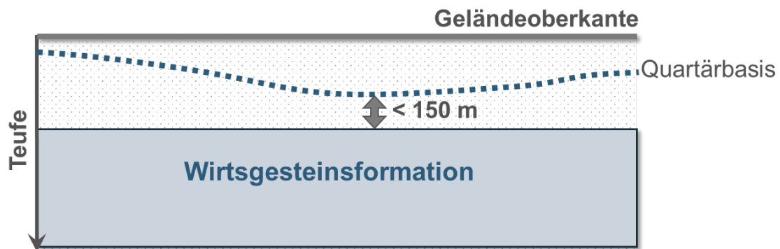
Abbildung 5: Schematische Darstellung der Überprüfung des Abstandes zwischen der Wirtsgesteinsformation und der Quartärbasis, wenn die Wirtsgesteinsformation tiefer als 100 m und unterhalb des Quartärs liegt. Es wird geprüft ob der Abstand zum Quartär größer als 150 m ist. Im gezeigten Fall sind die Indikatoren „Überdeckung des einschlusswirksamen Gebirgsbereichs mit grundwasserhemmenden Gesteinen, Verbreitung und Mächtigkeit grundwasserhemmender Gesteine im Deckgebirge“ und „Verbreitung und Mächtigkeit erosionshemmender Gesteine im Deckgebirge des einschlusswirksamen Gebirgsbereichs“ mit „bedingt günstig“ bewertet, weil der Abstand kleiner als 150 m ist.
