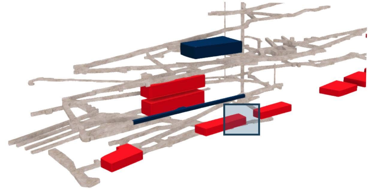
Die Messstelle vor der Einlagerungskammer 8 wird in regelmäßigen Abständen abgepumpt. Zuletzt war dies am 15. Januar 2026 der Fall. Dabei wurde rund 950 Liter Salzwasser abgepumpt. Das Abpumpen erfolgte davor zuletzt am 17. Dezember 2025. Für diesen Zeitraum ergibt sich eine durchschnittliche Fassungsrate von 30,4 Litern Salzwasser pro Tag.
