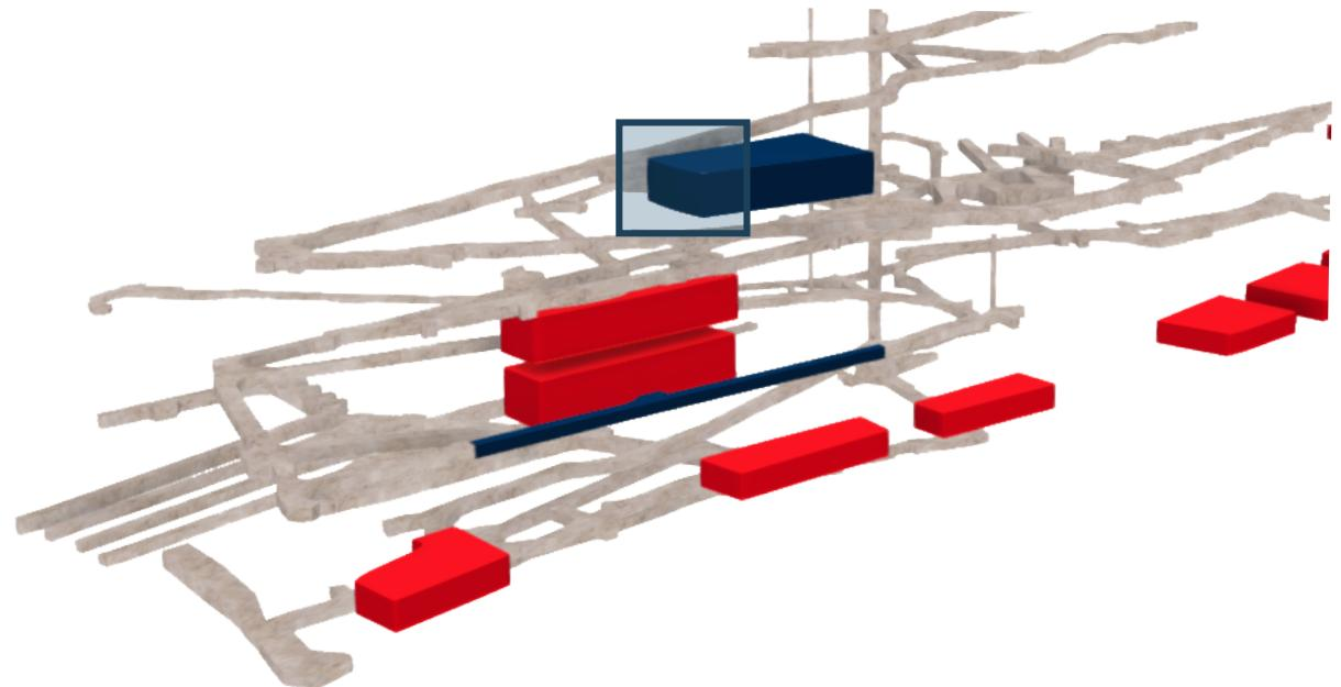
\* Der Salzwasserzutritt hat sich von der Bohrung 9.19 auf die danebenliegende Bohrung 9.25 verlagert. Seit dem 5. Dezember 2025 wird das hier gefasste Salzwasser über einen Durchflussmengenzähler in den Behälter vor dem Abbau 3, auf der 658-Meter-Ebene (ehemalige Hauptauffangstelle) geleitet.
