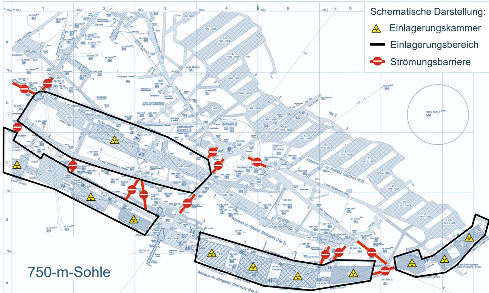
Die Strömungsbarrieren **behindern** und **verzögern** den Austrag von Radionukliden, durch
