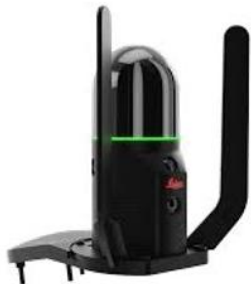
Laserscanner für mobilen Einsatz Sichtfeld: 360° (horizontal) / 270° (vertikal) Reichweite: 0,5 - 25 m Punktmessbereich: 420.000 Punkte/Sek.
