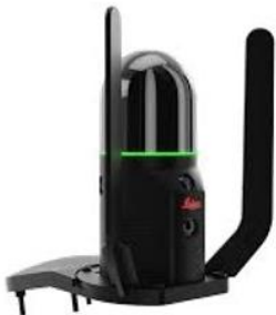
Laserscanner für mobilen Einsatz Sichtfeld: 360° (horizontal) / 270° (vertikal) Reichweite: 0,5 - 25 m Punktmessbereich: 420.000 Punkte/Sek.
