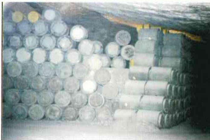
Abbildung 2: Einlagerungskammer 7/750, gestapelte verlorene Betonabschirmung (VBA)
