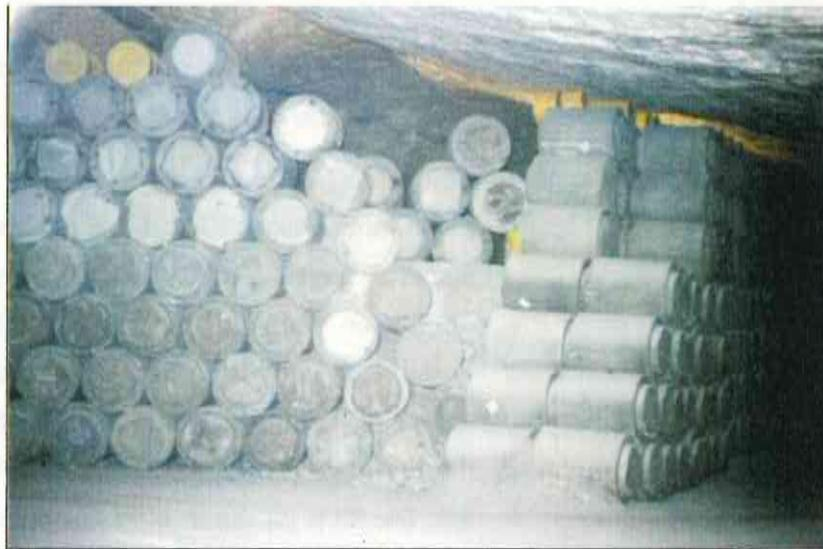
Abbildung 15: ELK 7750, gestapelte verlorene Betonabschirmung (VBA)
