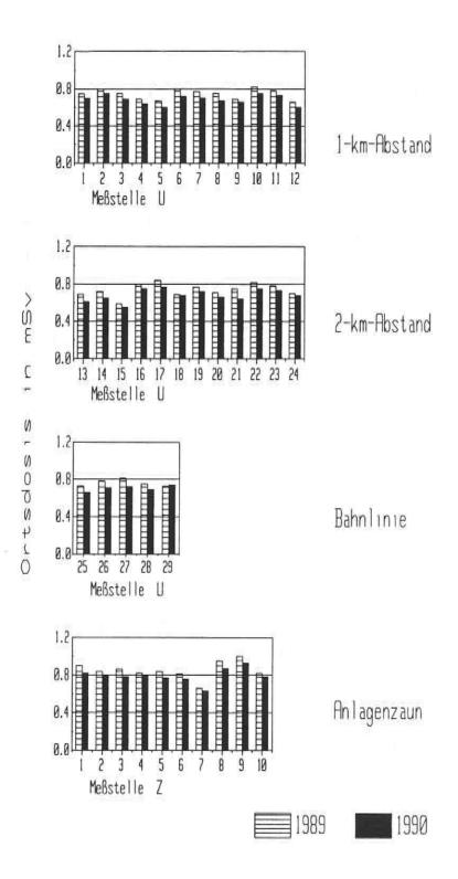
Abb. 4: Jahres-Ortsdosis in der Umgebung der Schachtanlage Asse 1989 und 1990. Meßstellen U1 - U29 und Z1 - Z10 lt. Abb. 3 bzw. Tab. 7
