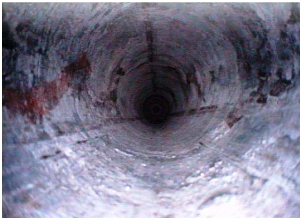
Foto 4k: Ausbrüche und Spuren von Carnallit bei 48,20 m
