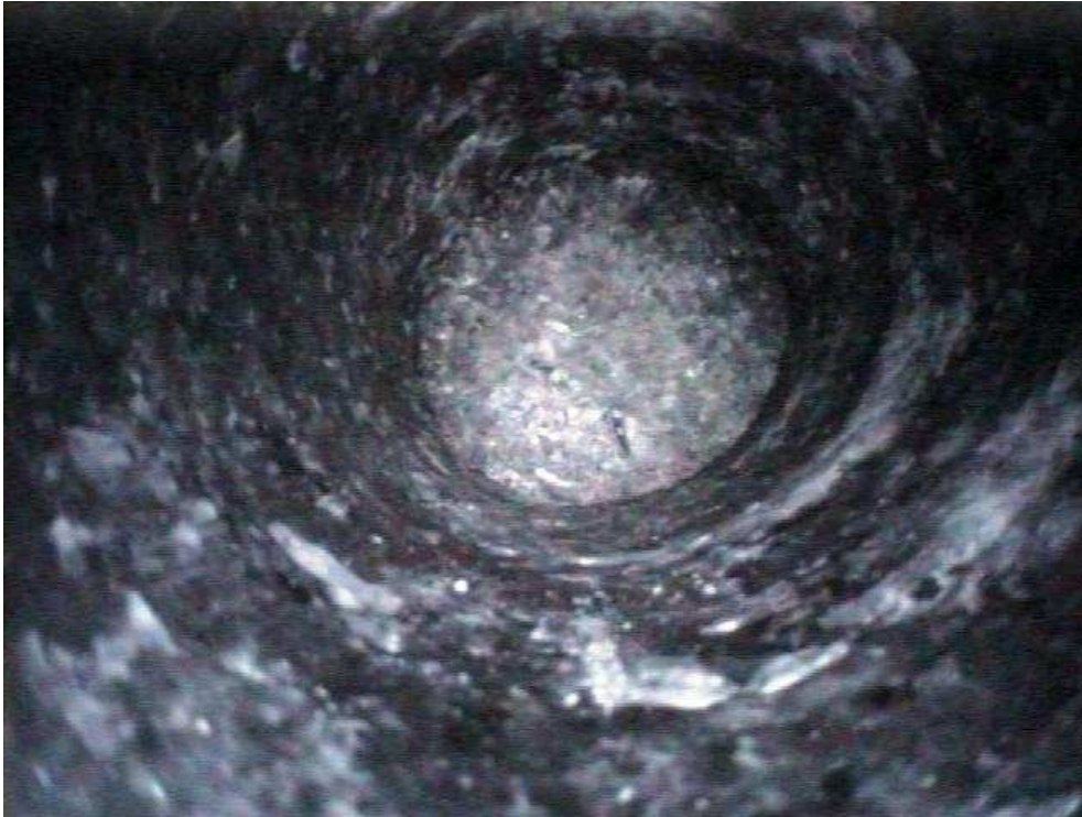
Foto 9e: Bohrlochende bei 56,89 m, leicht elliptisch
