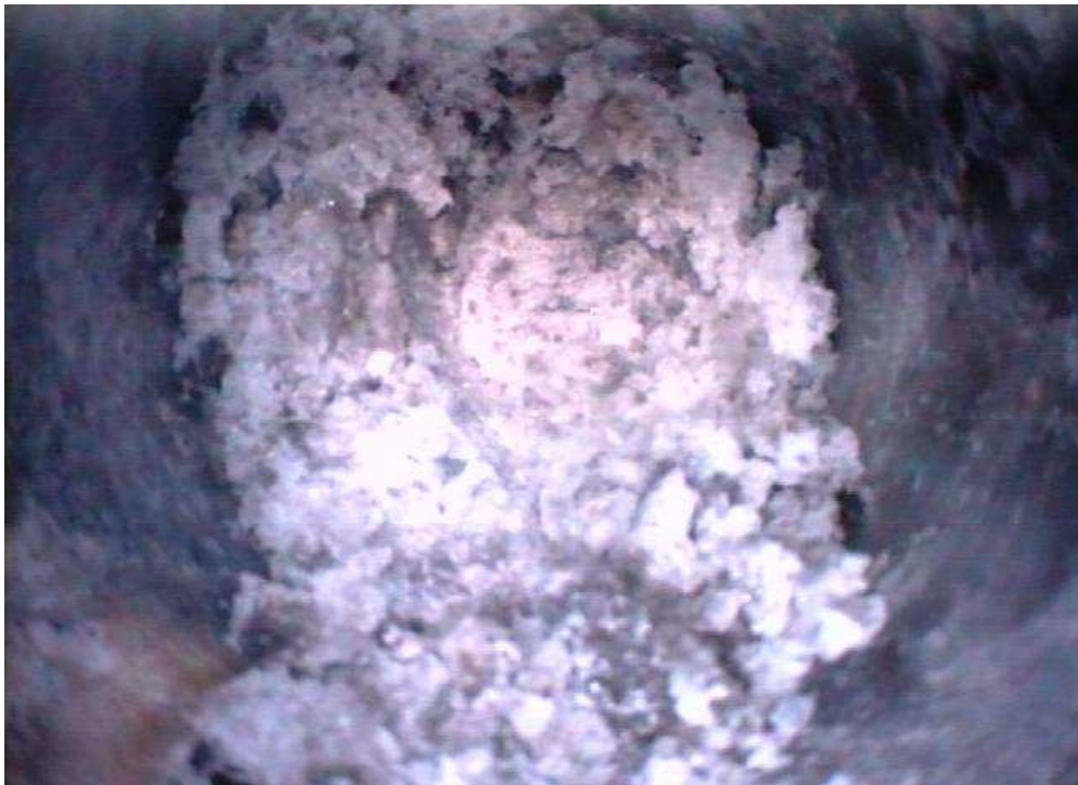
Foto 1e: Ausbruch und Bohrlochende bei 57,99 m Teufe
