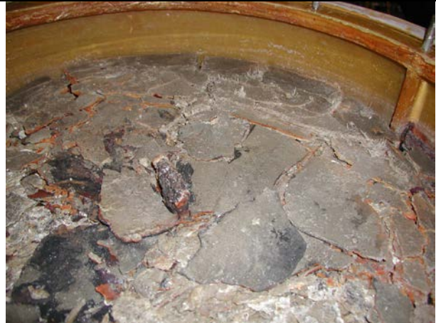
Probekörper #33 nach 17.1 Jahren Auslaugung in MgCl_2 -Lösung
