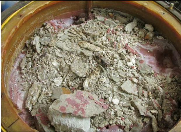
Probekörper #36 nach 23.3 Jahren Auslaugung in MgCl_2 -Lösung
