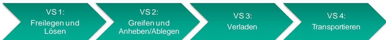
Abbildung 1: Verfahrenstechnische Kette bestehend aus den einzelnen Verfahrensschritten (VS)
