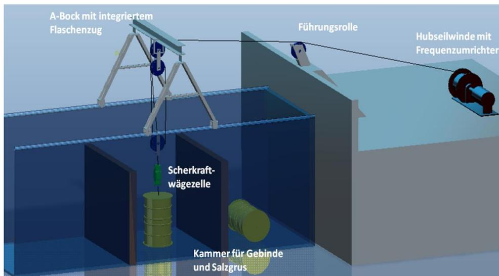
Abbildung 3: Schematischer Aufbau des Versuchstandes der Zugversuche
