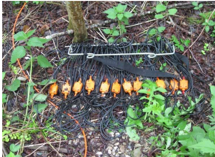
Abbildung 4: An die Messauslage angeschlossene Geophone empfangen die seismischen Signale (links). An einem Empfangspunkt ausgelegte Geophongruppe aus 12 Geophonen (rechts).
