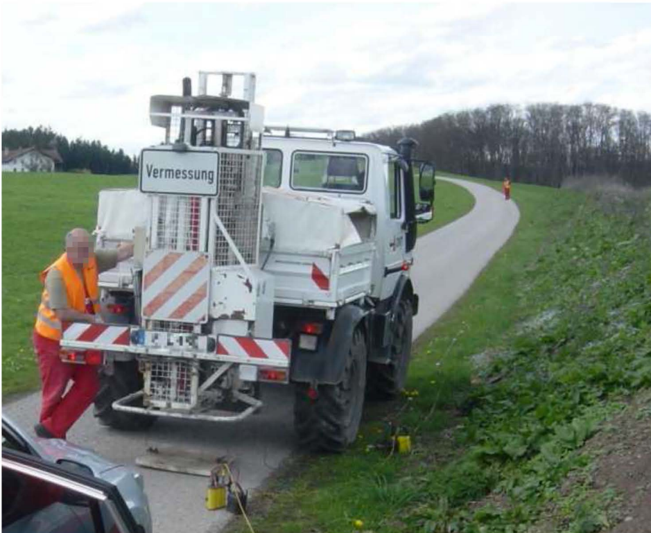
Abbildung 3: Nahlinienmessung mit einem beschleunigten Fallgewicht als Quelle.
