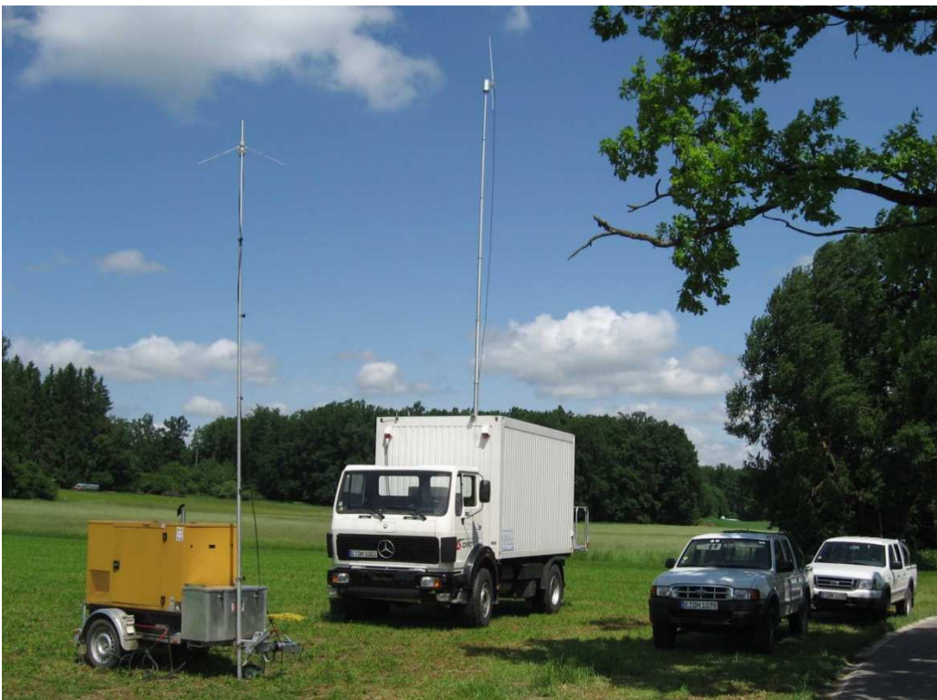
Abbildung 5: Messfahrzeug von dem aus die seismische Messung kontrolliert und in dem die Messdaten aufgezeichnet werden. Die Geophonauslage ist per Kabel an das Messfahrzeug angeschlossen.
