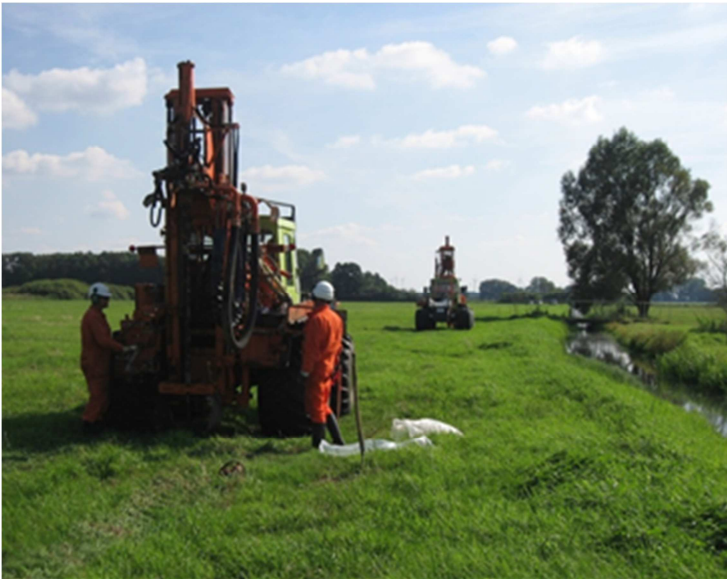
Abbildung 10: Bohrgeräte auf MB-Tracs (links) und Handbohrgerät im Einsatz (rechts) .
