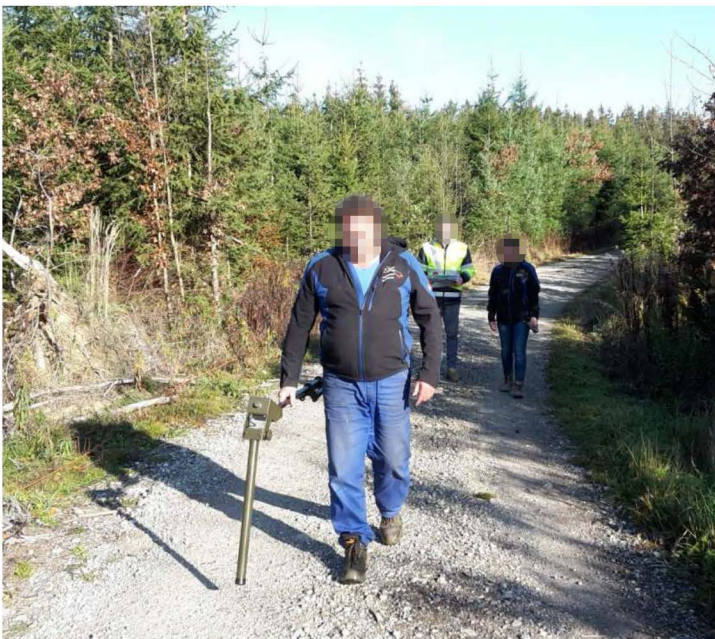
Abbildung 2: Kampfmittelsondierung mit einem Fluxgate-Magnetometer.
