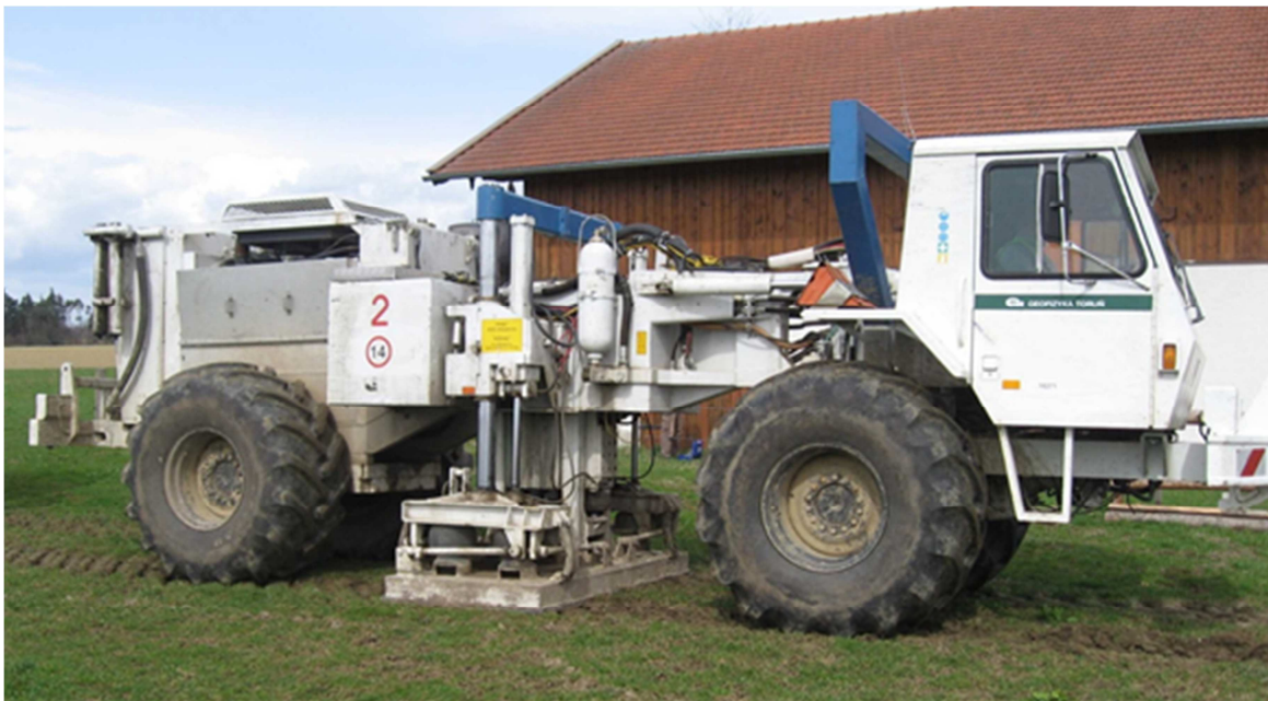
Abbildung 8: Vibrationsfahrzeug Mark IV mit Vibrator Hemi 50.
