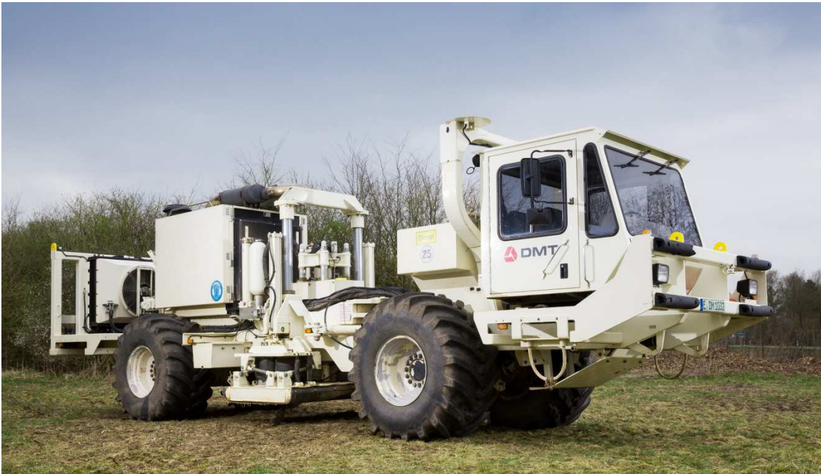
Abbildung 9: Vibrationsfahrzeug AHV-IV mit Vibrator PLS-362.
