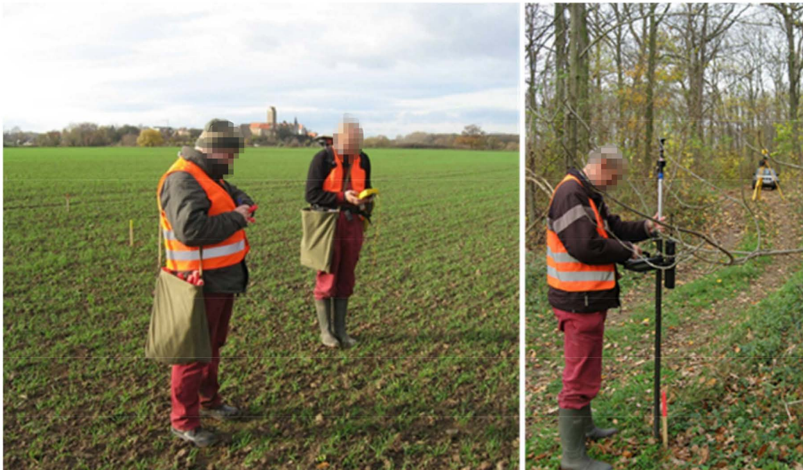
Abbildung 1: Vermessung mit GPS (links) oder Tachymeter (rechts). Markierung von Empfangs- und Anregungspunkten mit Pflöcken.
