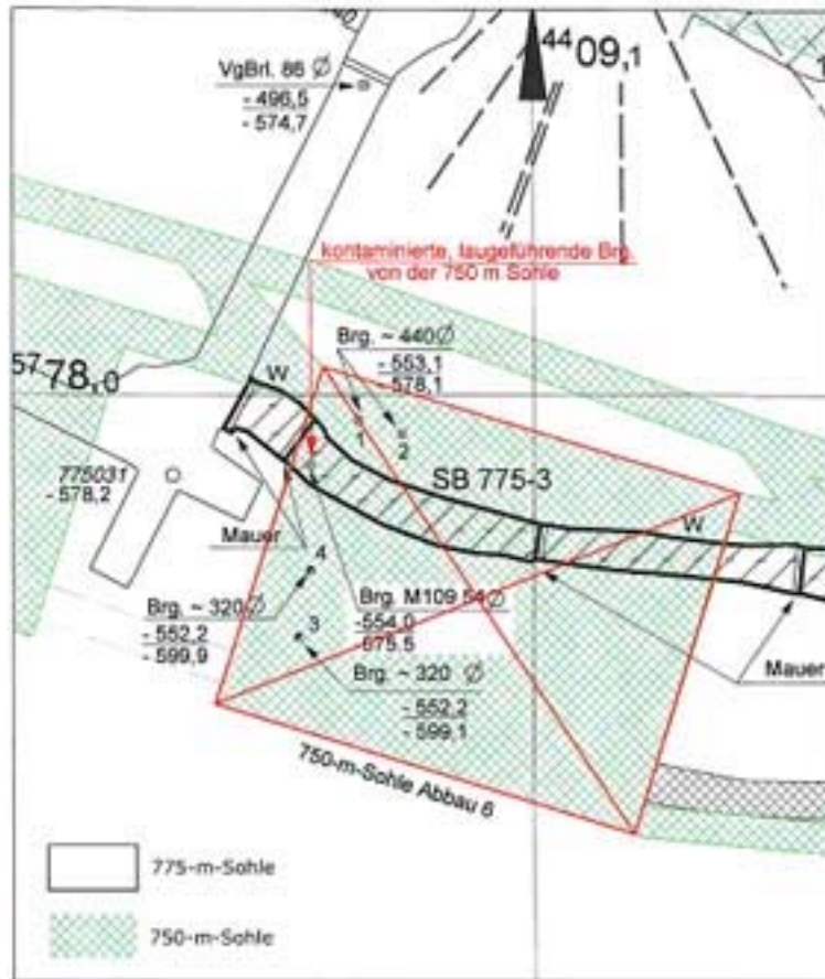
Abbildung 9 : Messstelle M 109, Bohrung verpresst
