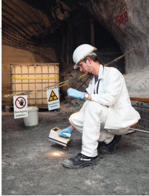
Verstärkter Strahlenschutz: Messung auf der 750-Meter-Sohle
