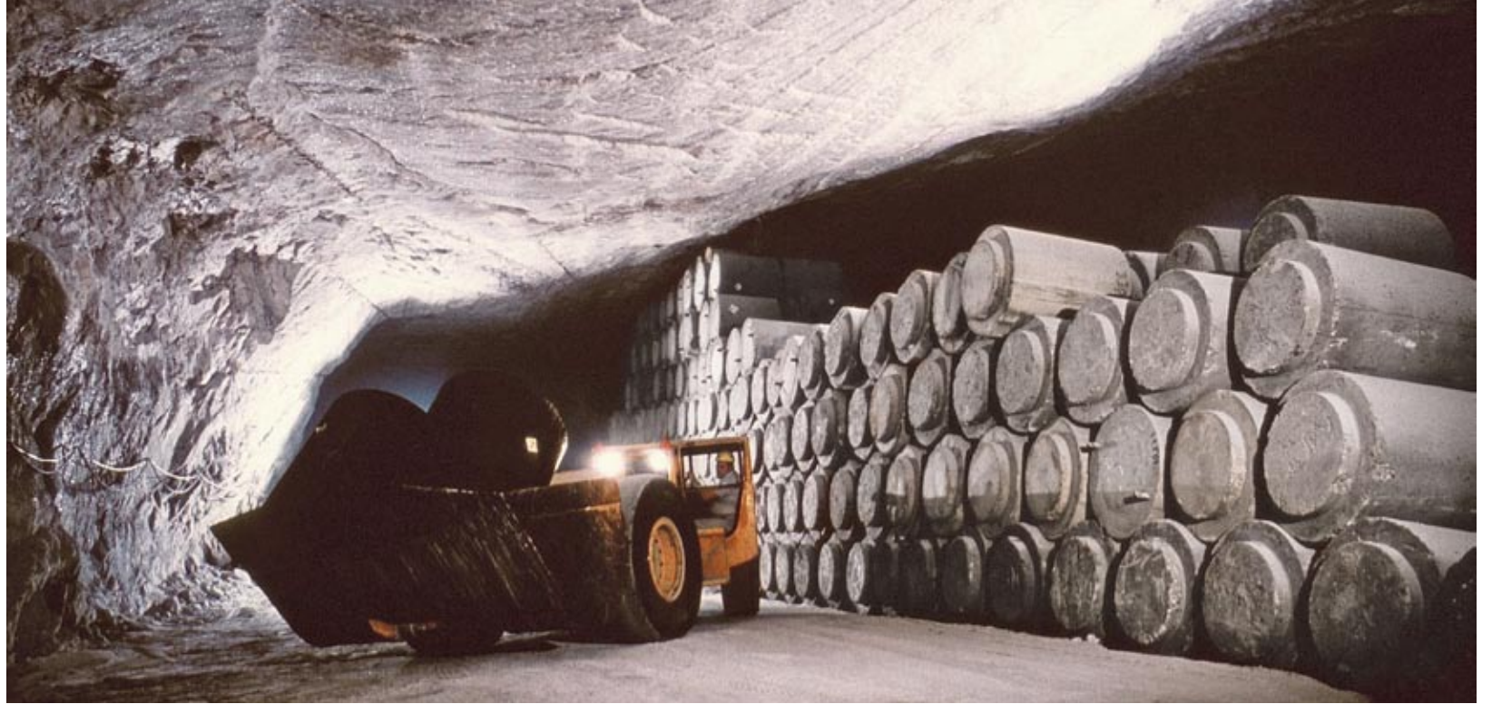
EINE EINLAGERUNGSKAMMER, IN DER DIE ABFALLFÄSSER MIT EINER SOGENANTEN VERLORENEN BETONABSCHIRMUNG GESTAPELT WURDEN
