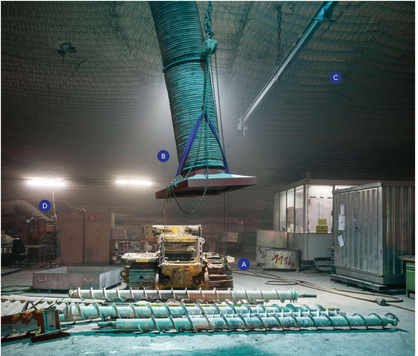
Der Demontage- und Freimesstplatz für betriebliche Abfälle in 490 Metern Tiefe
