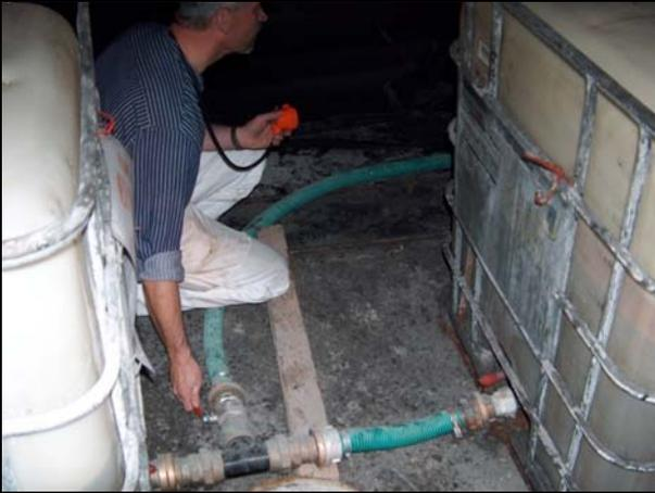
**Photo 14:** Probenahme SB1-PN aus 2 Behältern mit je 1 m<sup>3</sup> über Verbindungsleitung
