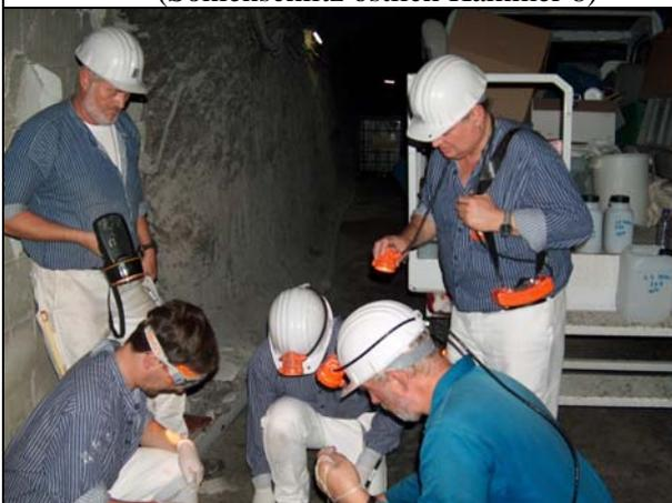
**Photo 66:** Entnahme Laugeprobe MP L3
