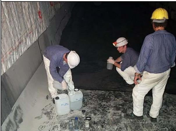
**Photo 24:** Probenahme aus Zwischenspeicher 658-m-SohleT(MP 27-Z)
