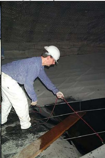
Photo 12: Probenahme SB1hu mit Schöpfgerät
