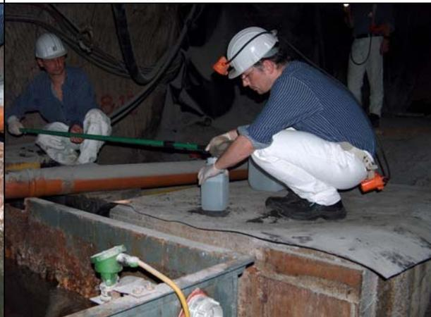
**Photo 23:** Füllen von Probebehälter 2,5-Liter am MP 27-Z
