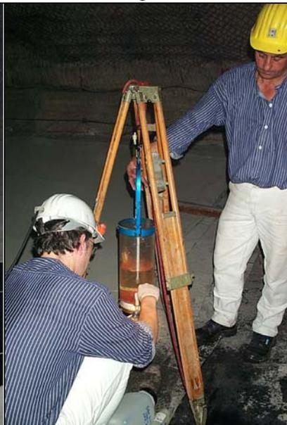
Photo 13: Füllen Probengefäß aus Schöpfgerät
