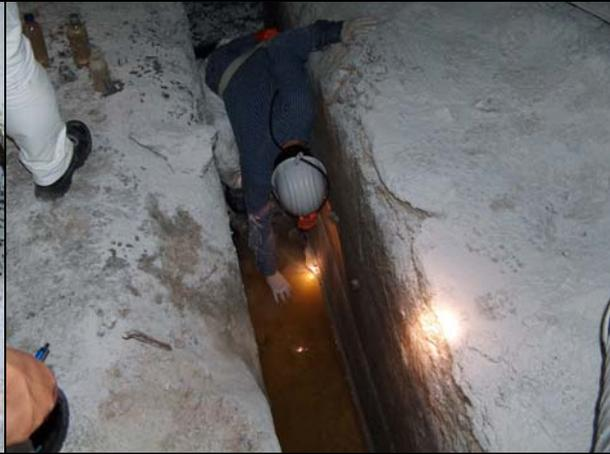
**Photo 45:** Probenahme aus Sohlenschlitz MP L6
