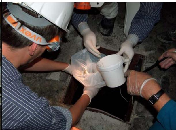
**Photo 67:** Entnahme Feststoffprobe MP L3-F
