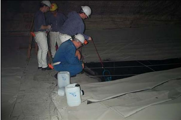
Photo 09: Probenahme SB1ho mit Schöpfgerät
