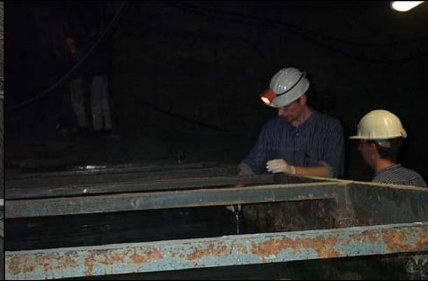
**Photo 21:** Probenahme 27-S, Füllen 0,5-Liter-Flaschen
